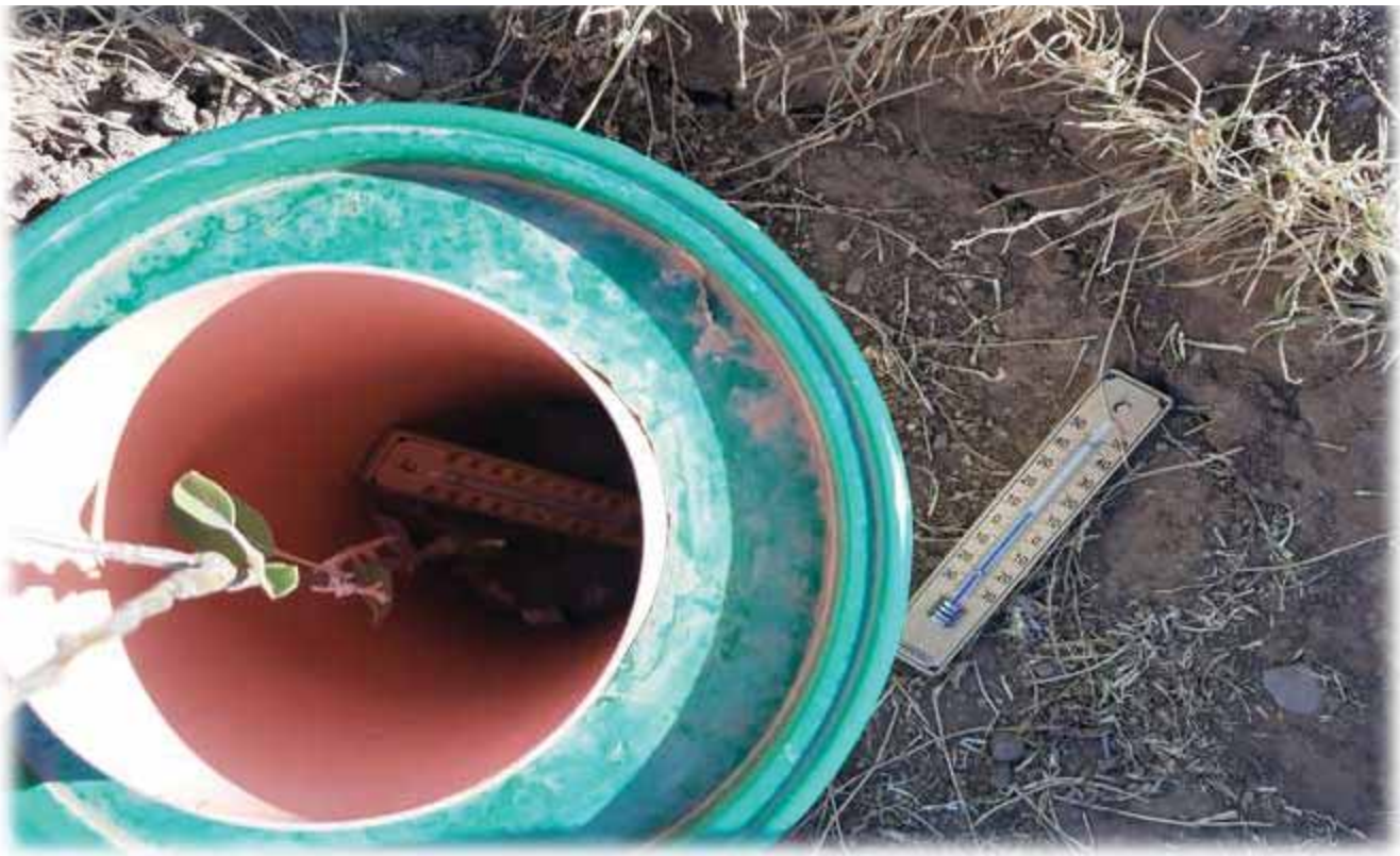
Fotografía N° 44: Medición de temperatura con termómetro ambiental.
