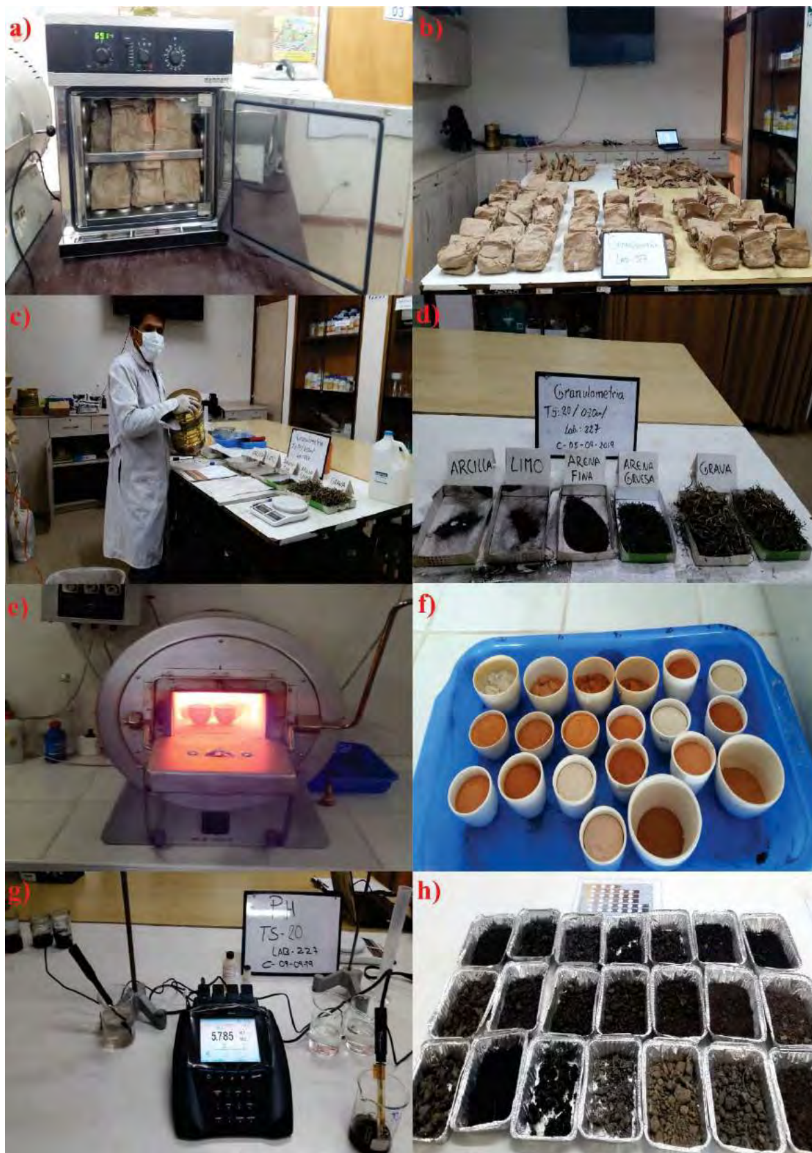
Evaluación de suelos en gabinete. a) Estufa para secado de muestras. b) Muestras para humedad relativa, densidad aparente y textura de suelo. c) Tamizado de muestras de suelos. d) Textura de suelos. e) Horno mufla para materia orgánica. f) Muestras de suelos obtenidos por ignición. g) Ph del suelo. h) Estructura y Características hidromórficas del suelo
