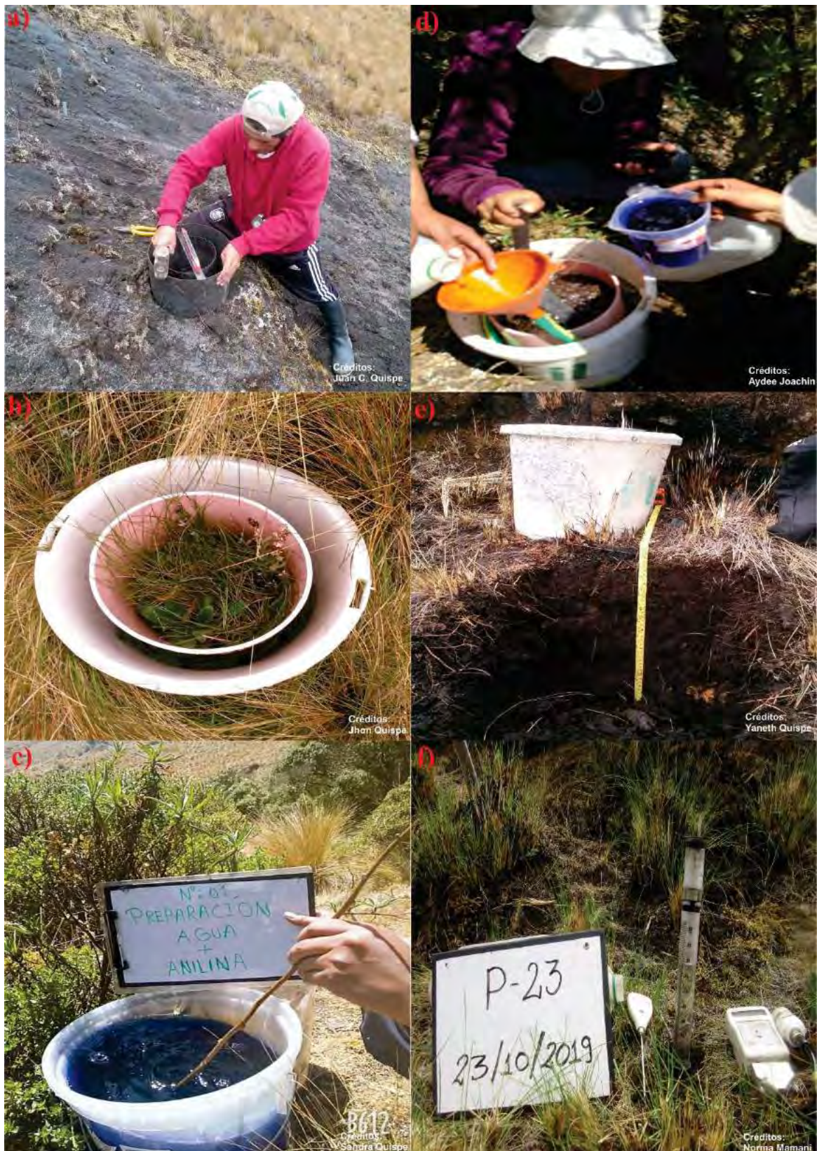
Proceso de Infiltración. a) Instalación del infiltrómetro de doble anillo. b) Diámetros del doble anillo D1=20 cm, D2=30 cm. c) Combinación de agua y anilina para identificar flujo lateral. d) Saturación del anillo externo e interno. e) Presencia de flujo lateral, profundidad 30 cm. f) Infiltrómetro mini disco, sensor de humedad y termómetro ambiental.
