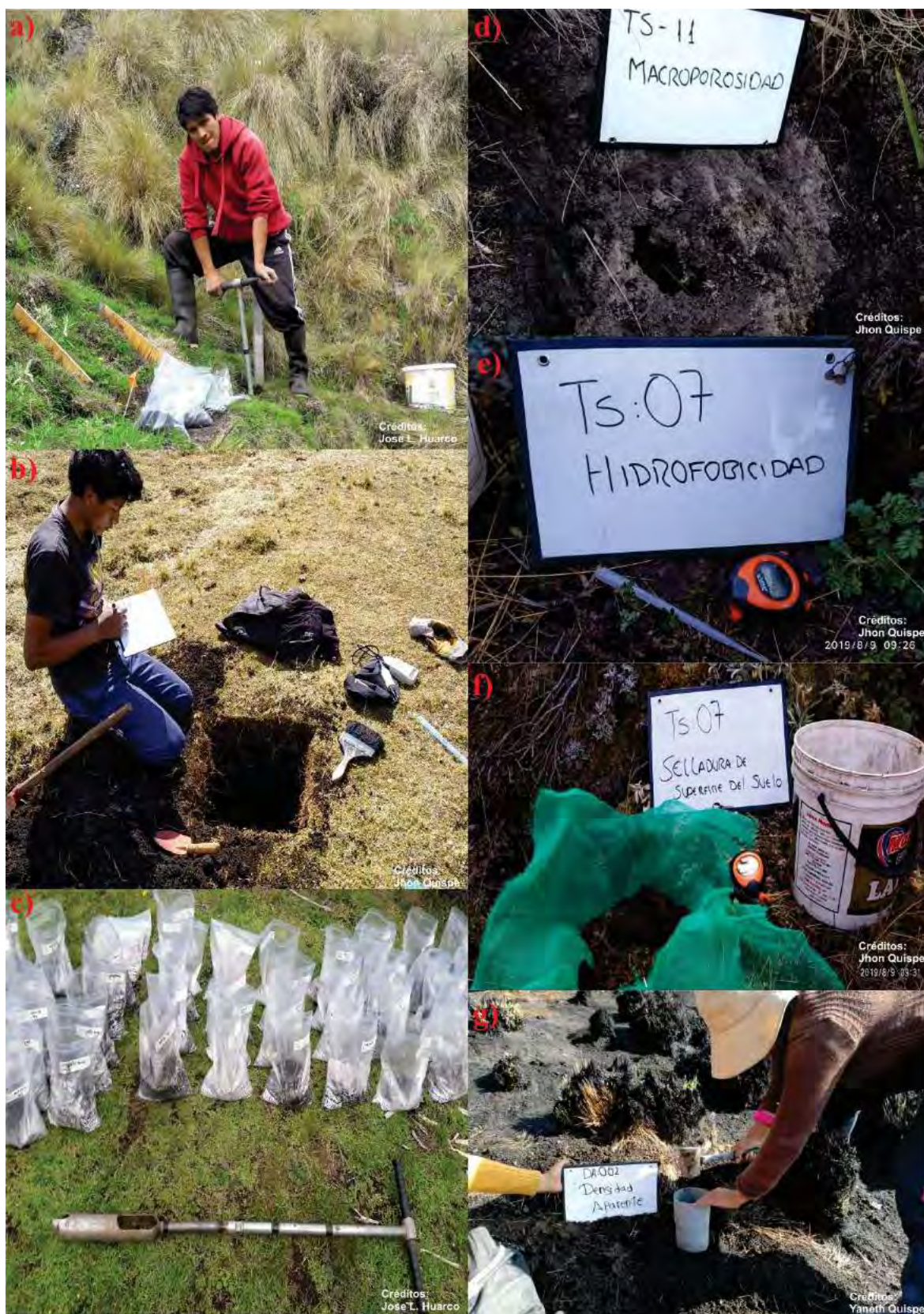
Toma y análisis de suelos. a) Extracción de suelos con barreno de 2 m. b) Calicata de 25x25x50 cm. c) Rotulado de muestras de suelos. d. Evaluación de Macroporosidad e) Evaluación de Hidrofobicidad. f) Evaluación de la Selladura de la superficie del suelo. g) Evaluación densidad aparente.
