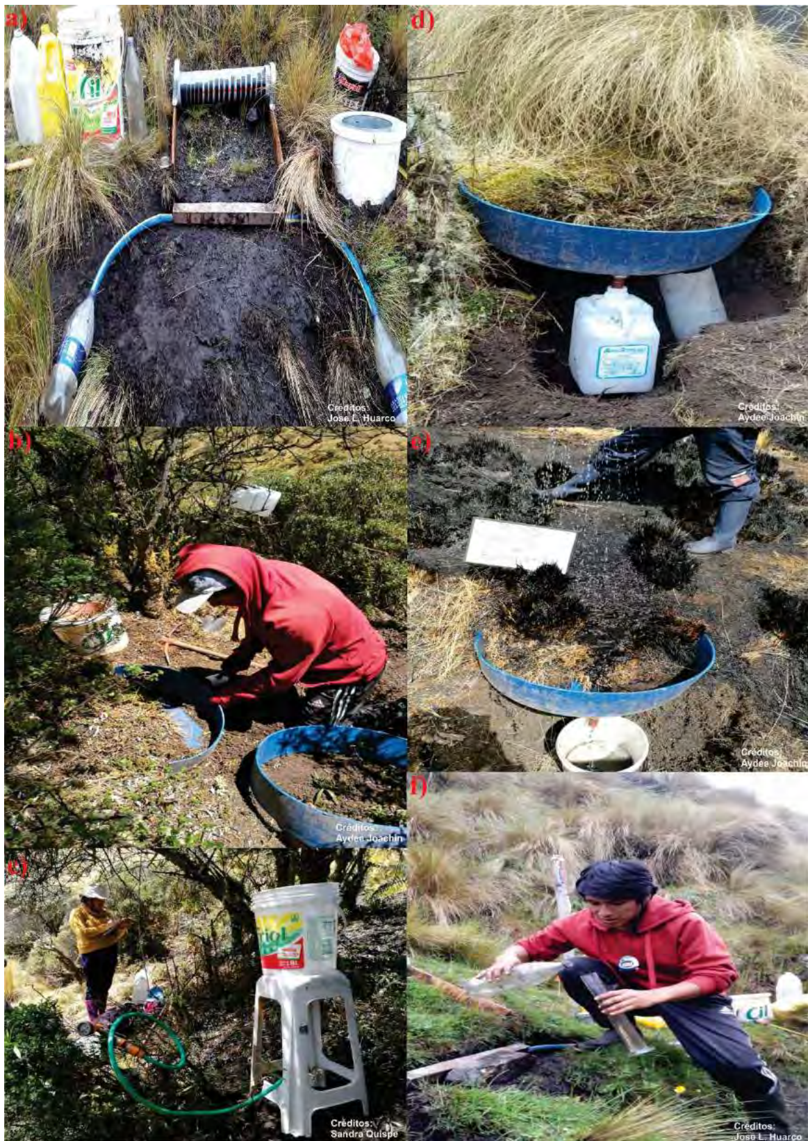
Proceso de Escorrentía. a) Simulador de escorrentía 1. b) Instalación simulador de escorrentía 2. c) Simulador de precipitación con temporizador incluido. d. Colector de escorrentía e) Simulación de precipitación con una intensidad de 30 mm/hora. f) Medición de escorrentía con probeta graduada de 1000 ml.
