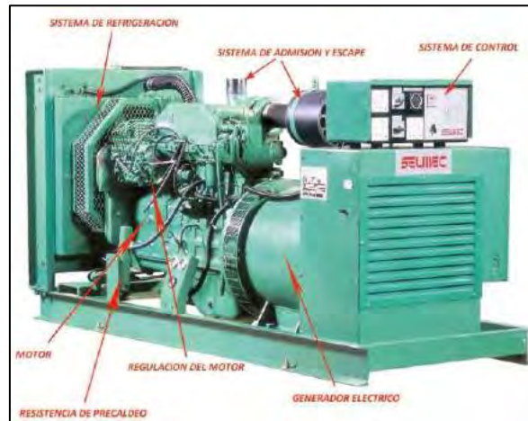
Figura 2.4. Componentes de un grupo electrógeno. Fuente: https://www.demaquinasyherramientas.com
