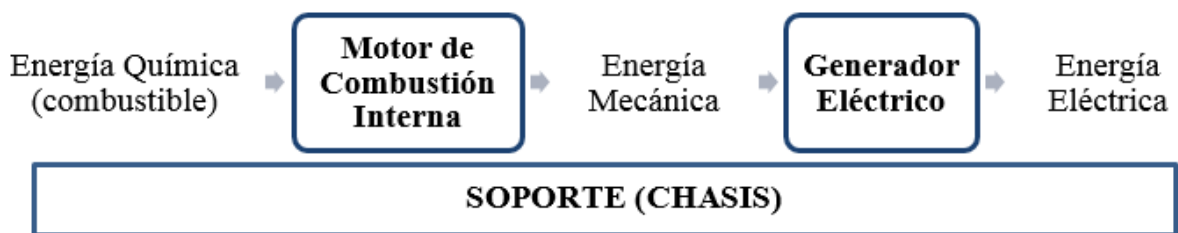
Figura 2.2. Representación general de grupos electrógenos. Fuente: Autoría propia.
