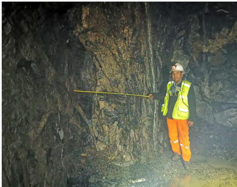
Fotografía 20. Se observa Veta Daysi potencia de 3 mt, Gal 470 NO, con mayor presencia de mineralización. Fuente: Elaboración propia.
