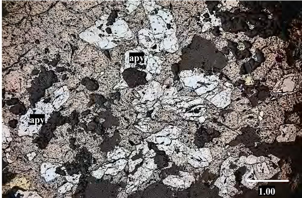
Fotomicrografía N° 19: Cristales subhedrales de arsenopirita (apy) englobados por agregados masivos de pirrotita (po). Fotomicrografía en LR-NP.
