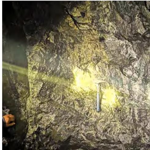
Fotografía 38: Presencia de Pirrotita en venillas y masiva en la veta en interior mina. Fuente: Elaboración Propia.
