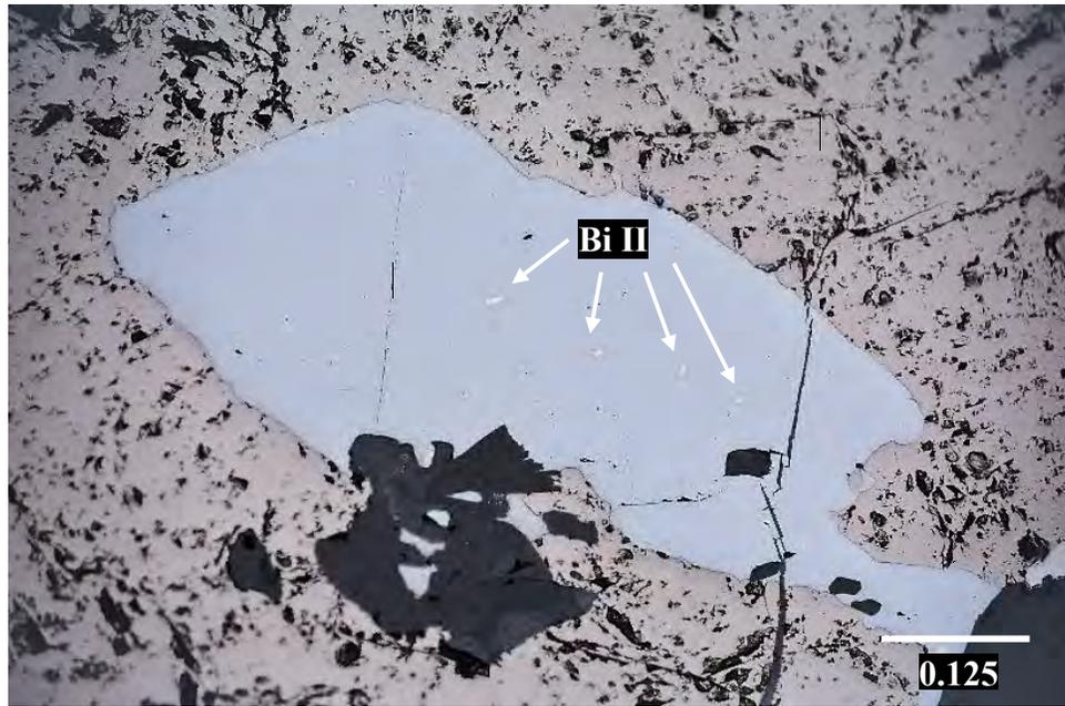
Fotomicrografía N° 29\_ Cristal de galena (gn) con inclusiones (1e I) de bismuto II (Bi II). Pirrotita (po). Fotomicrografía en LR-NP.
