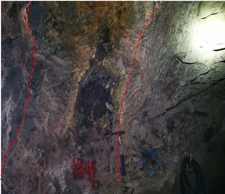
Fotografía 21. Se observa Veta Daysi Gal 280 NO, Zona 4, con mayor presencia de mineralización.
