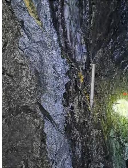
Fotografía 39: Calcopirrita con relleno masivo en fracturas. Fuente: Elaboración Propia.
