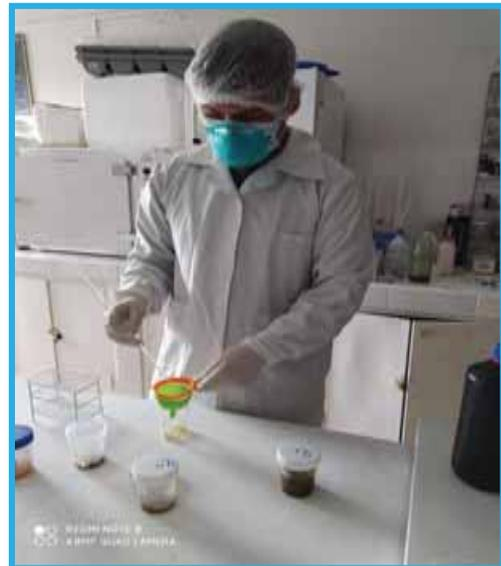
**Figura N° 11:** Se realizó el Trasvasado al tubo de centrifugación.
