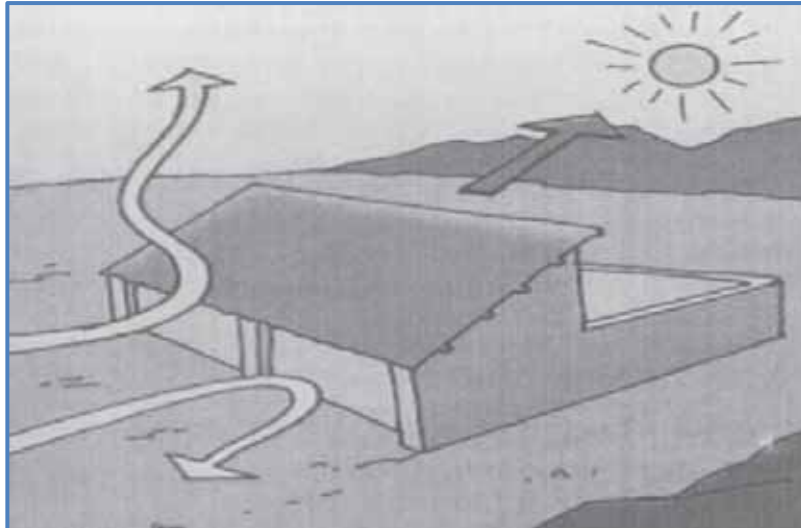
Figura 05. Orientación del miniestablo respecto al sol y los vientos dominantes (PRONAMACHS PUNO, 2007).
