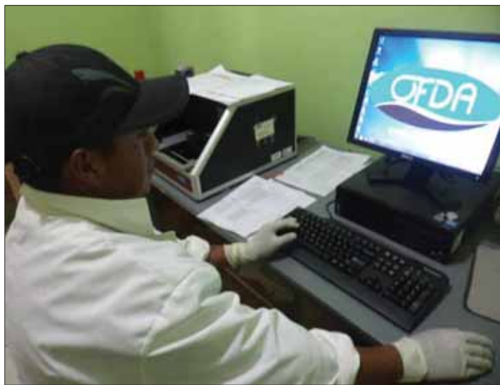
Foto 13: Determinando la finura de fibra por OFDA 2000.
