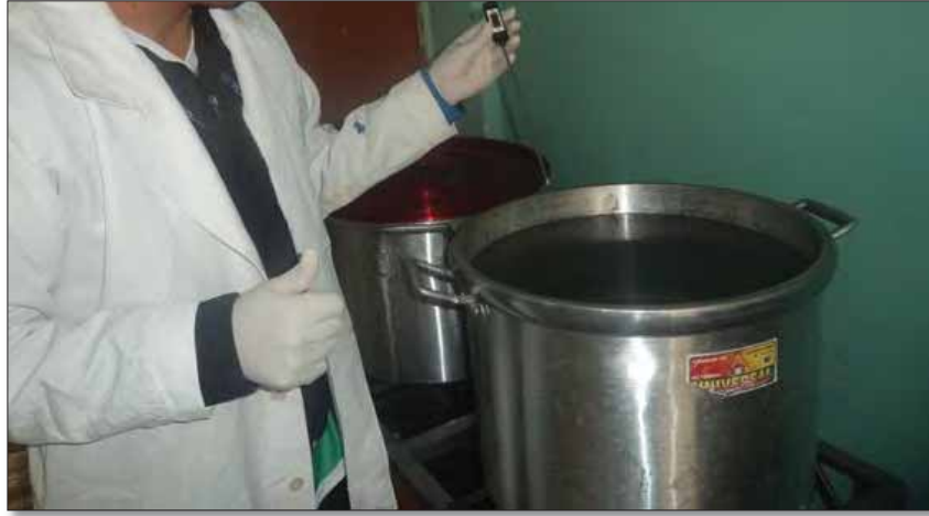
Foto 01: Calentamiento del agua para el lavado de muestras de fibra
