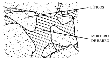
SE USO EL MORTERO DE BARRO EN EN LA ESTRUCTURA DE LOS RECINTOS, COMO MUROS (RECINTO RB12) (Ver foto 86)
