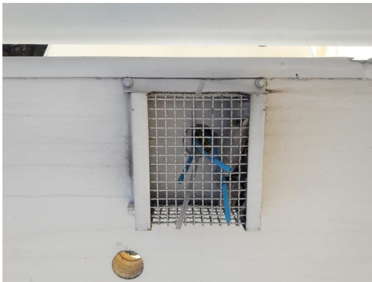
FOTO 2: Parte trasera conectada del equipo ANALIZADOR DE CO 2 SERINUS EC 9820 (MARCA ECOTECH) al captador de CO 2 , ubicado a 1.5 m sobre el suelo.
