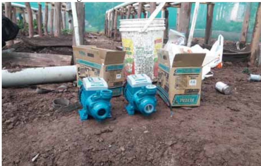
Fotografía 5: Electrobombas de 0.5 HP
