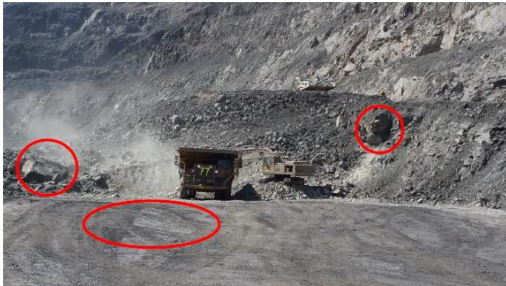
Figura 1.-Boloneria y pisos desnivelados después de la voladura
