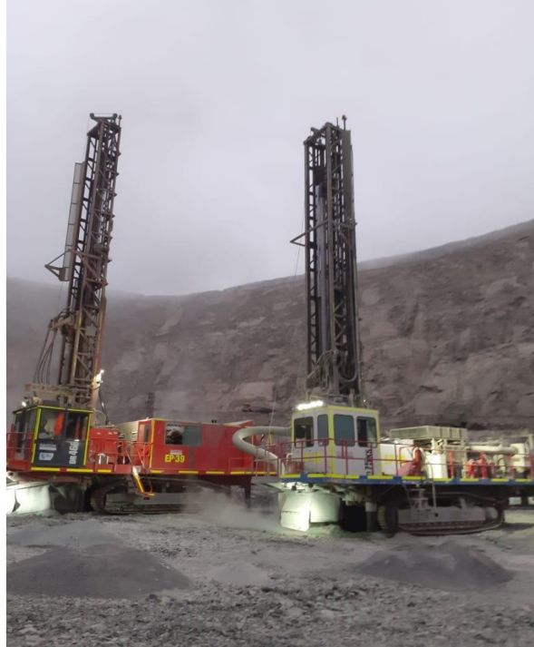
Figura 35.- Equipo de Perforación de Diámetro 11” y 12”
