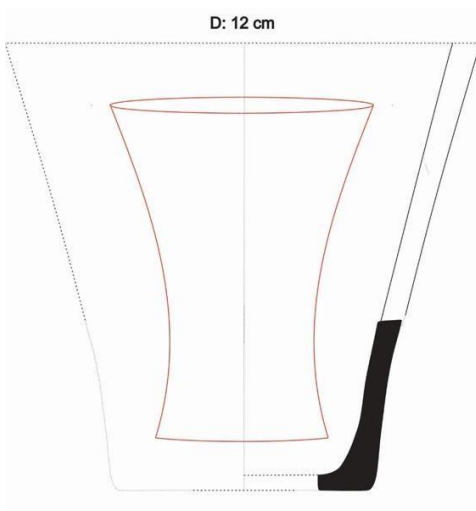
Figura 176 Dibujo de corte en el que resalta el cuerpo hiperboloide en vaso killke, el cuerpo de tipo hiperboloide esta redibujado en color rojo.
