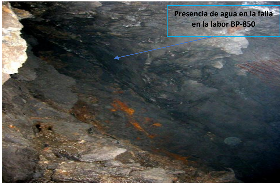
Imagen N° 2.1: Presencia de agua en la Falla del BP- 850
