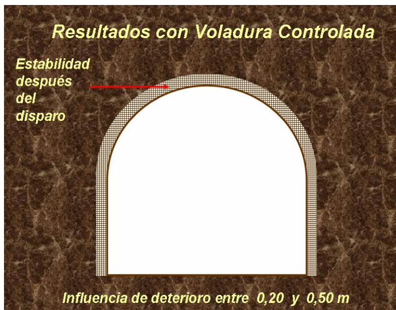
Grafico 4.19 –Efectos por voladura controlada.
