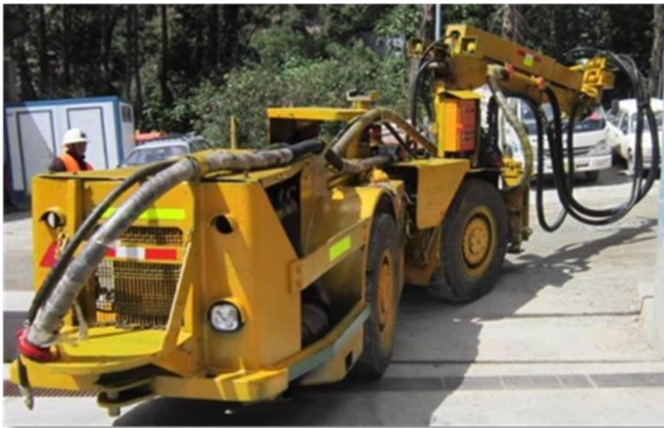
Figura 4.22 – Lanzador de concreto N° 04
