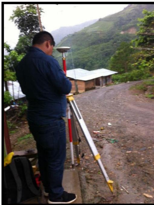
*Foto 27. Levantamiento con GPS diferencial*
