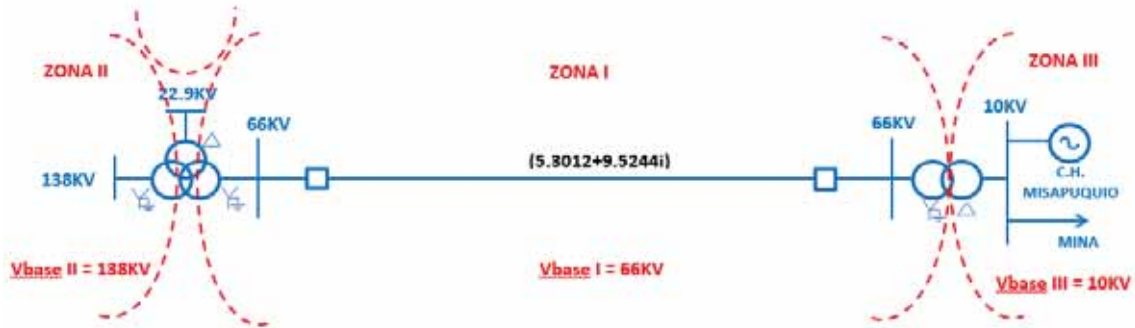
Figura 33: Cálculo de impedancia en p.u. línea L-6018 Fuente: Elaboración propia
