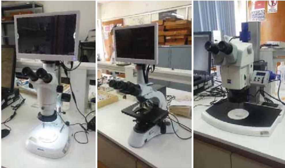
**Figura 13.** Equipos ópticos para observación y toma de microfotografías
