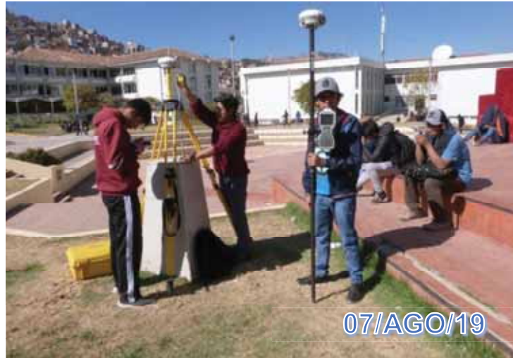
Figura 25: Levantamiento topográfico con GPS diferencial Fuente: Fotografía Propia
