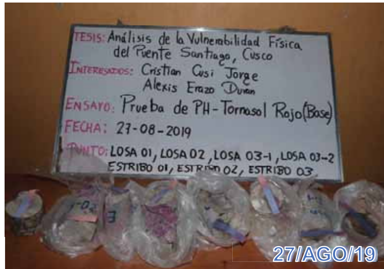
Figura 35: Prueba de PH, coloración azul (concreto base) Fuente: Fotografía Propia
