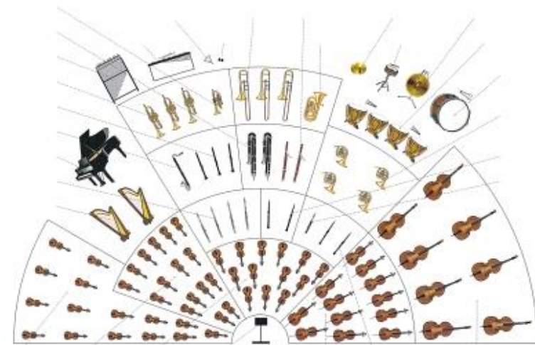
Imagen 173: Distribución de los instrumentos correspondientes a una orquesta sinfónica de gran tamaño, FUENTE: Antoni Carrión Isbert, (1998), Diseño acústico de espacios arquitectónicos, Edicions UPC
