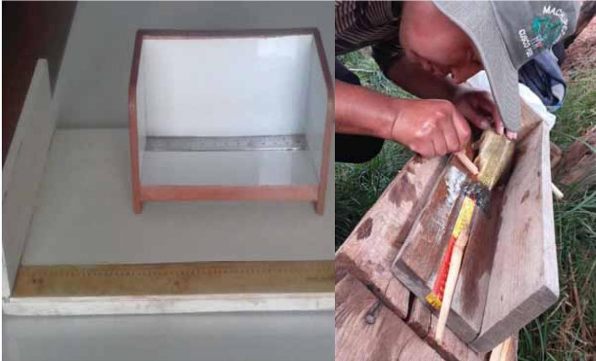
Foto 2: Instrumento de medición Ictiometro de 40 cm, precisión 1 mm.
