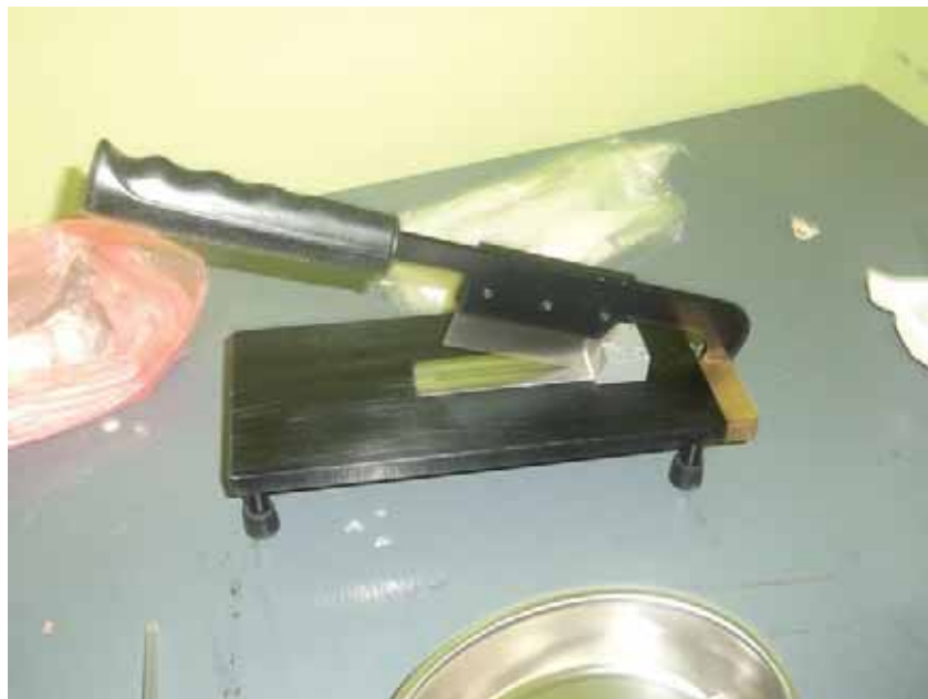
Foto 4: Guillotina para cortar la fibra.
