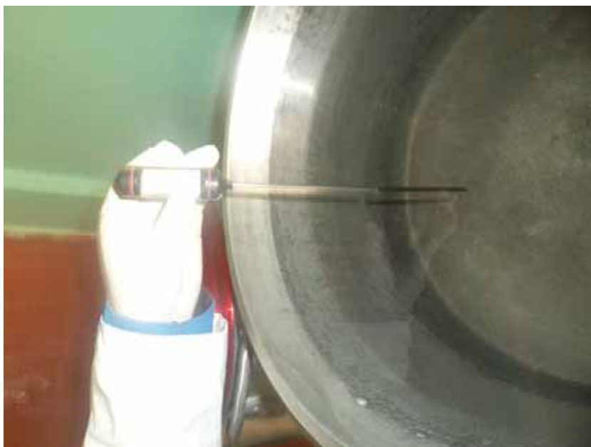
Foto 8: Medida de temperatura del agua.
