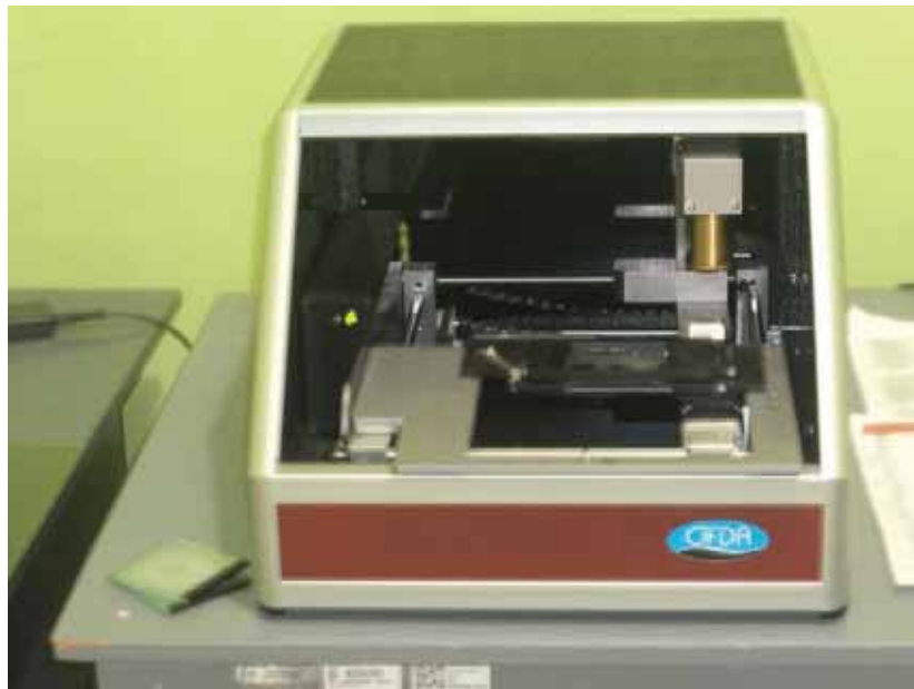
Foto 4: Guillotina para cortar la fibra.
