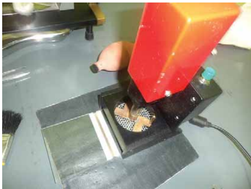
Foto 14: Distribuidor de muestra.
