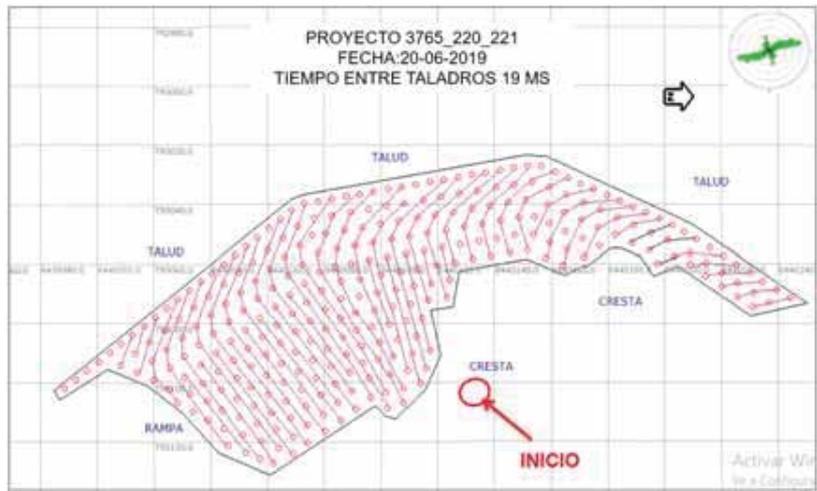
Figura 20: Diseño de voladuraFASE 2B 3765\_220-221, sin considerar taladros de recorte.
