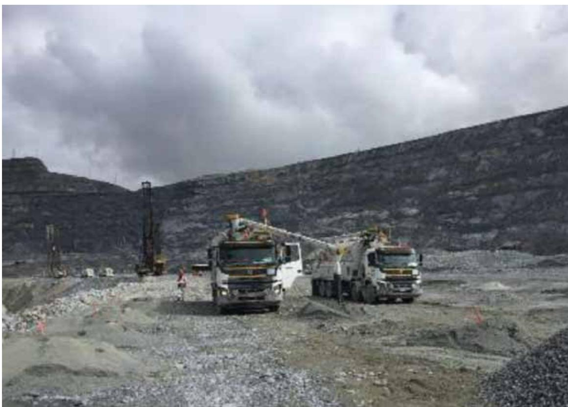
Figura 10. Carguío de taladros en malla - (Voladura Antamina).
