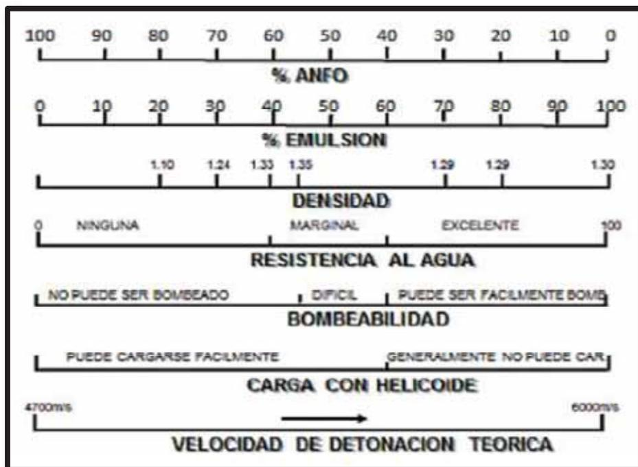
Figura 22. Características de diferentes mezclas de ANFO Pesado (Du pont, 1986)
