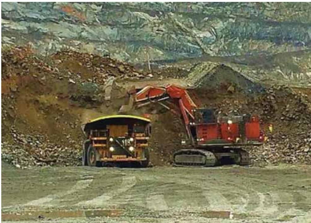
Figura 12. Carguío con la pala hidráulica Hitachi – (Operaciones mina).
