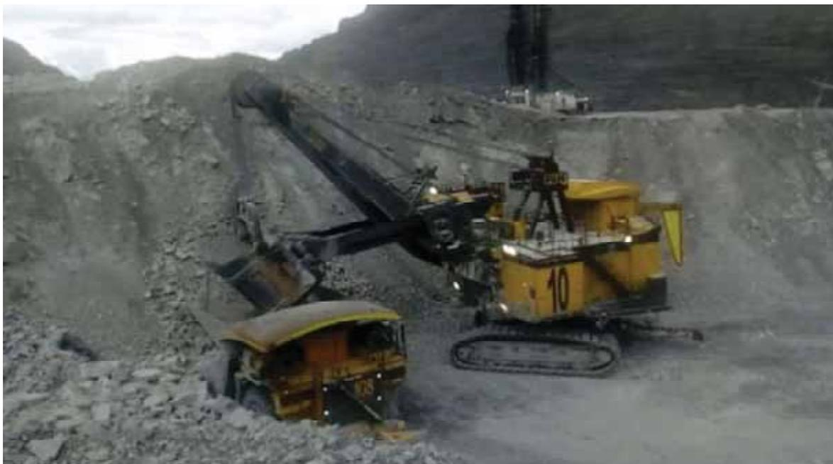
Figura 11. Vista de la pala eléctrica P&H – (Operaciones mina).
