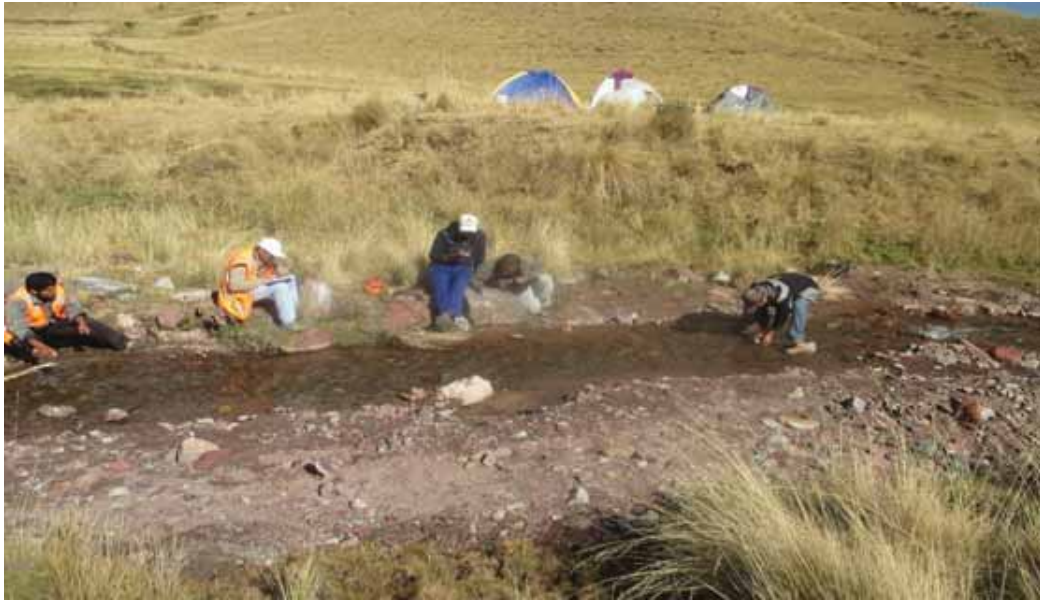
Fotografía 11: Aforo en río Ch'akil sector en Phaqchaq wayq'o-Puytoq. (Cuenca del Colorado).
