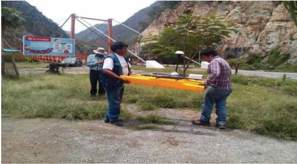
Fotografía 7: Aforo con el sistema Doppler ultrasónico OTT Qliner
