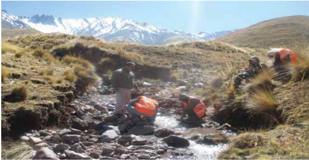
Fotografía 18: Aforo en la quebrada Phaqchaq pampa (Puytoq). Caudal =14.75 L/s.
