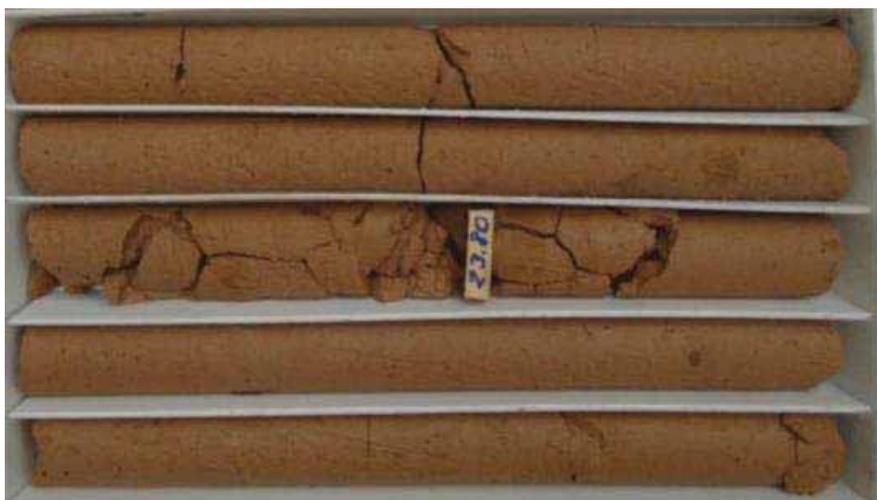
*Fotografía N° 51. Sondaje DHT-03 Caja 8 desde 22.30 hasta 25.20.*
