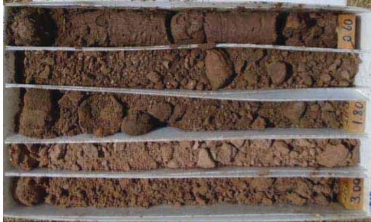
Fotografía N° 25. Sondaje DHT-01. Caja 1 desde 0.00 hasta 3.00.
