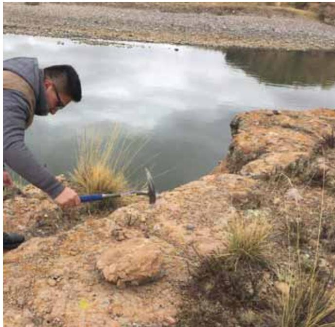
*Fotografía N° 6. Material geológico representativo en la zona de salida del túnel proyectado, que viene a ser toba volcánica residual, observamos que se halla erosionado y cubierto por material coluvial.*
