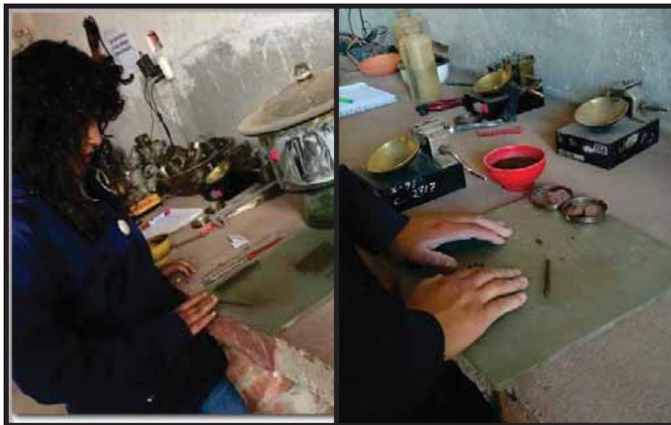
Fotografía N° 14. Ensayo de Limite Plástico.
