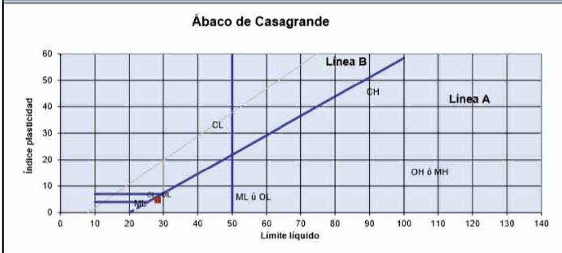
En la segunda perforación, en el ensayo de límites de consistencia se obtuvo que el material presente tiene un límite líquido de 28.48%, y un límite plástico de 24.24%. Lo cual indica que el Índice plástico es 4.74%, siendo este de baja plasticidad, demostrado en el gráfico.
