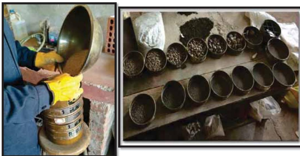
Fotografía N° 12. Ensayo Granulométrico.
