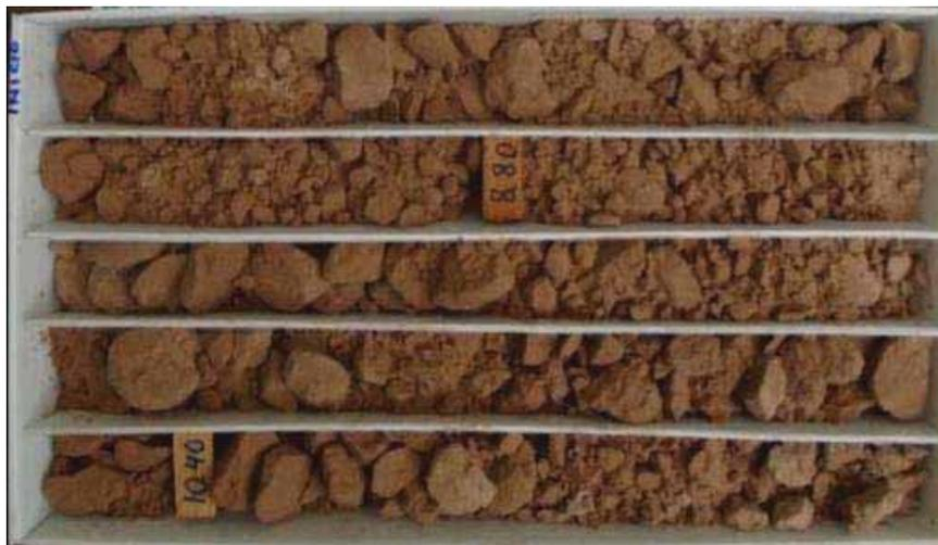
Fotografía N° 46. Sondaje DHT-03 Caja 3 desde 7.90 hasta 10.90.
