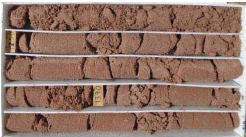
Fotografía N° 29. Sondaje DHT-01 Caja 5 desde 11.90 hasta 14.90.
