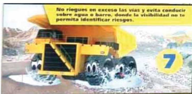
Figura n° 32: Recomendación de cuidado de neumático
