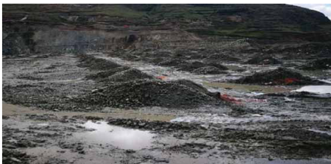
Figura n° 4: Malla de perforación con presencia de agua
