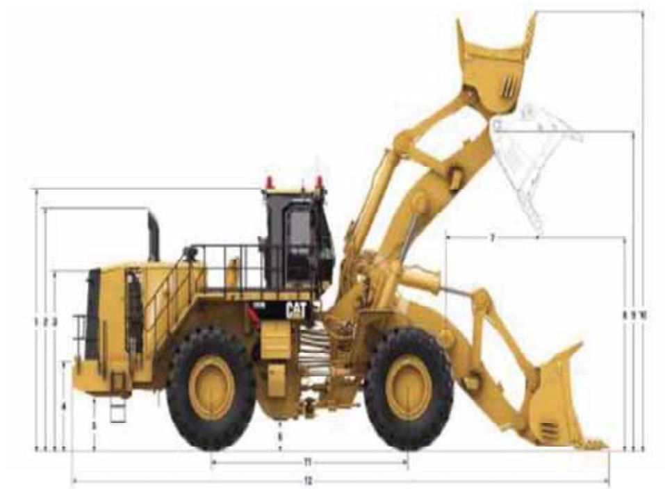
Figura n° 11: Dimensiones de cargador sobre ruedas CAT 992K.
