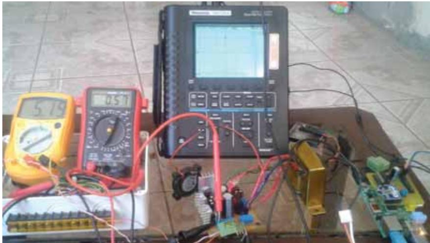
Figura 3.24 Instrumentación de medición de consumo de potencia.
