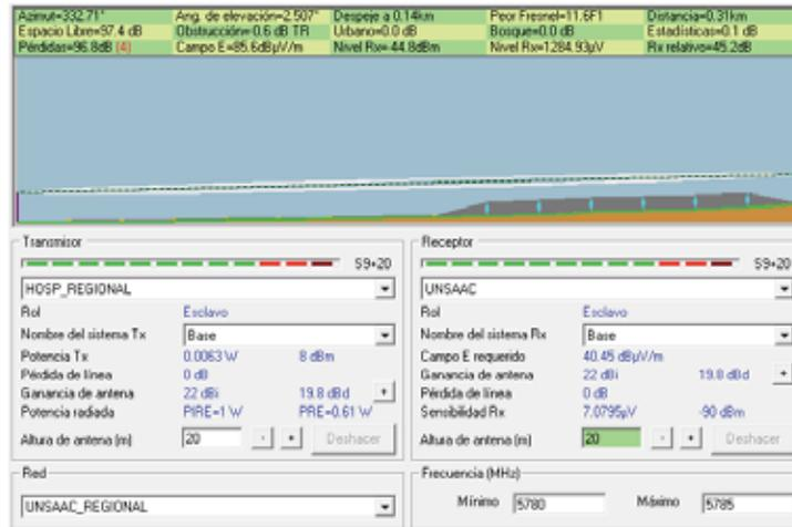
Figura 3.6 Simulación del enlace.
