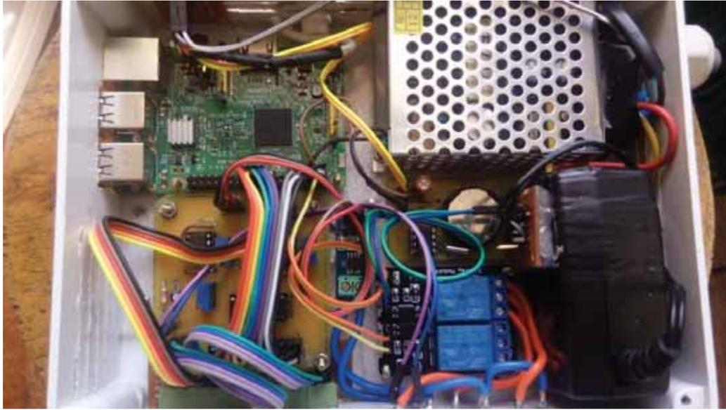
*Figura 4.18 Sistema de adquisición de datos implementado.*
