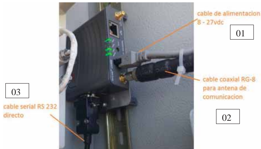
Figura 31: Conexiones del modem
