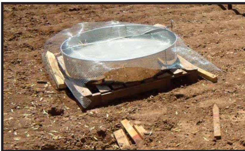
Fotografía 5. Tanque Clase A instalado en campo.
