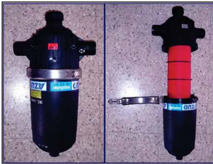
Figura 2. Filtro de anillas de 2" armado y desarmado.
