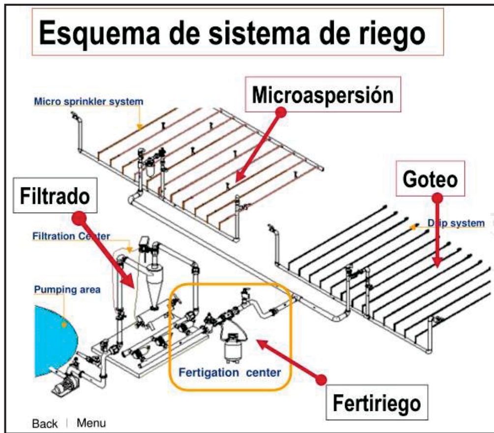
Figura 1. Esquema de un sistema de riego localizado.
