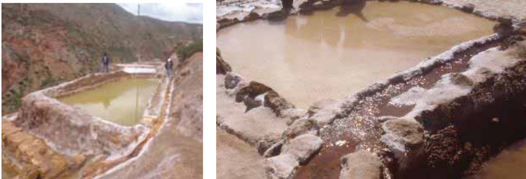
Llenado de pozas con agua salada (5cm) provenientes de los manantes Orqo pujio y China pujio y se deja por tres días, esta operación se repite a lo largo de 30 días.
