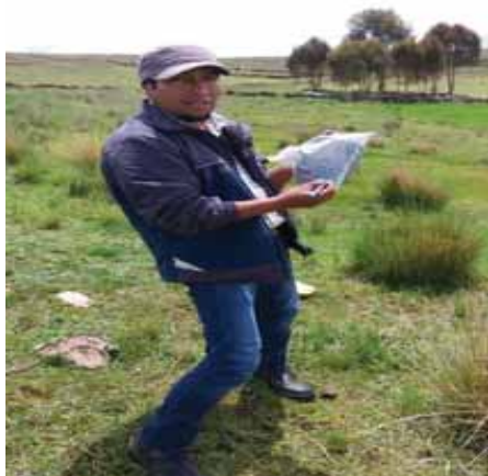
Foto 37: Las muestras de suelo se codifica en la bolsa con indeleble en Lauramarca.
