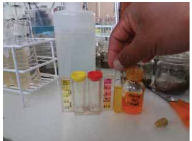
Foto 52: Comparación de pH con el colorímetro en el laboratorio de Cusco
