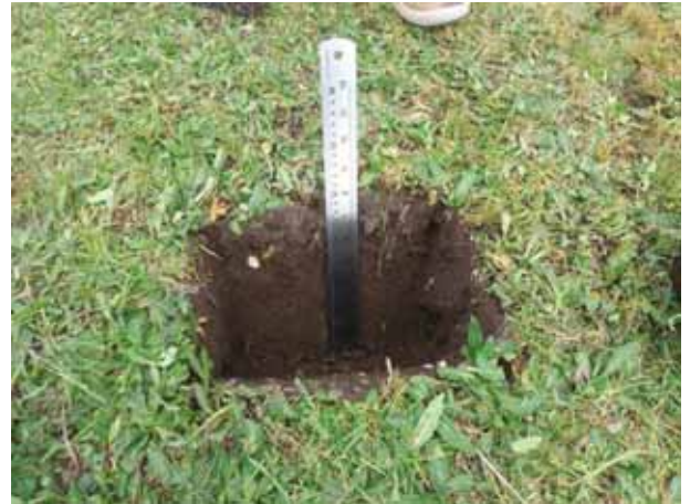
Foto 34: Se aprecia la profundidad del suelo con regla milimetrada en Lauramarca.
