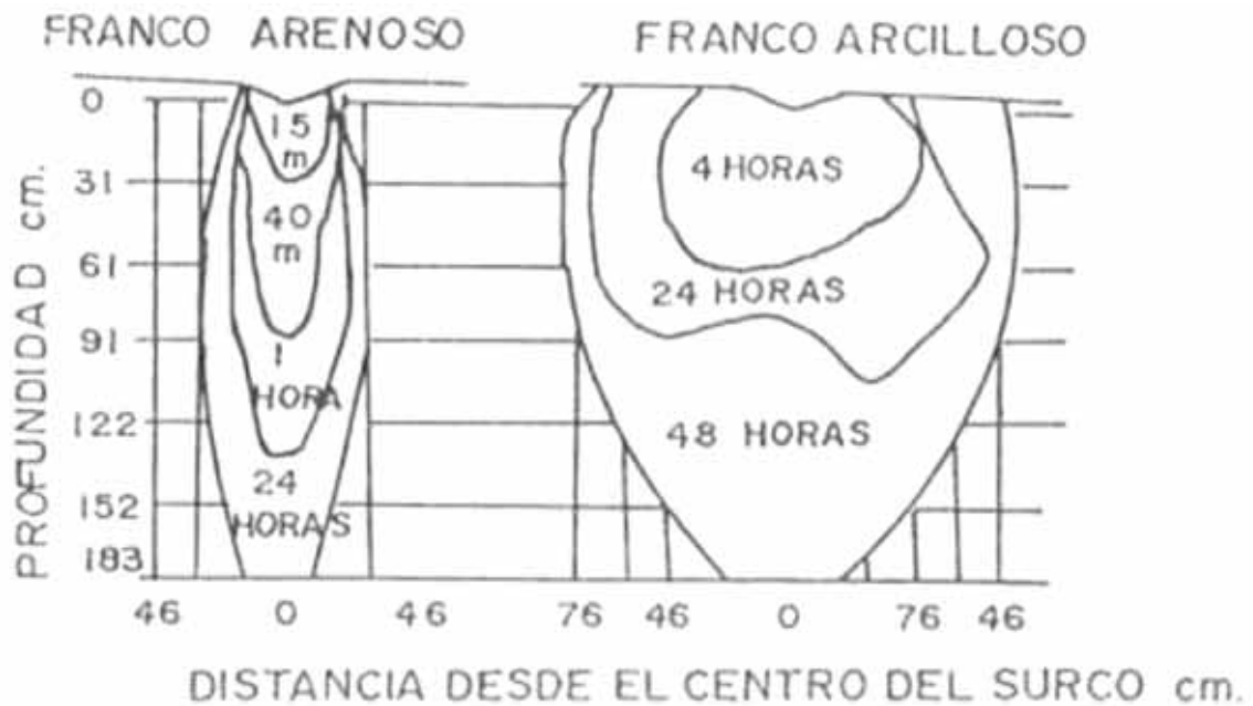
Figura N° 3. Velocidad relativa del movimiento de agua en el interior de dos suelos: franco arenoso y franco arcilloso.
