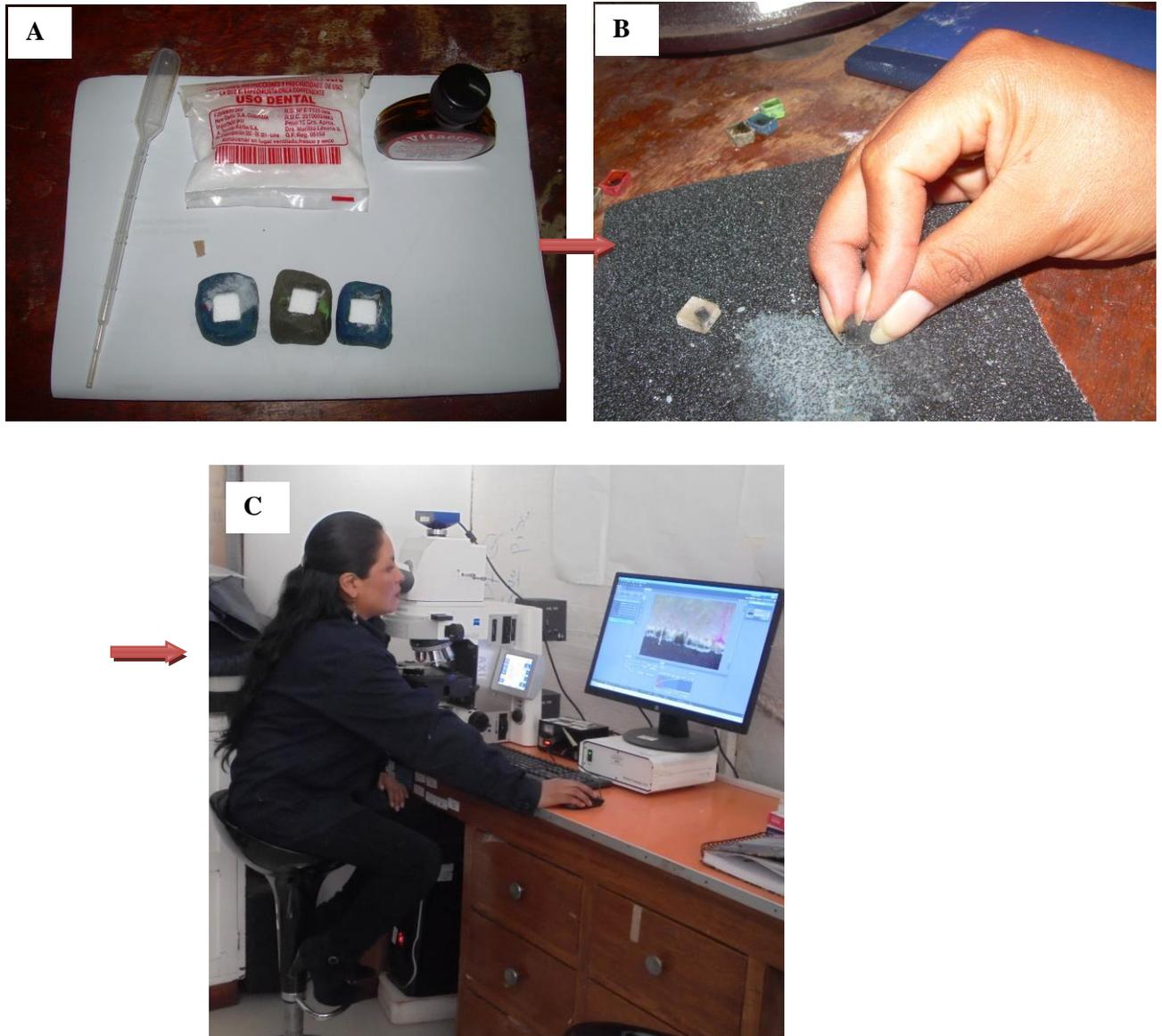
**Registro fotográfico del trabajo en campo:** Foto A: Materiales para la preparación de la resina acrílica en la que se incluirá la muestra de lítico a estudiar. **Foto B:** Lijado de la resina para posteriormente ser observada en el microscopio óptico, **Foto C:** Estudio de las estratigrafías con microscopía óptica en el laboratorio Físico-químico de la Dirección Desconcentrada de Culturas - Cusco.
