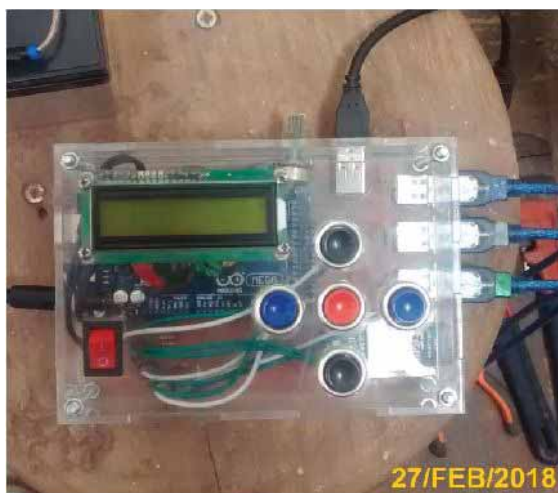
Imagen 3.4. Prototipo electrónico final.
