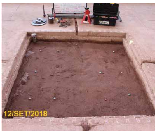
Imagen H.14: Pozo estratificado del modelo experimental antes y después de ensayos PDC. Fuente: Fotografías propias.
