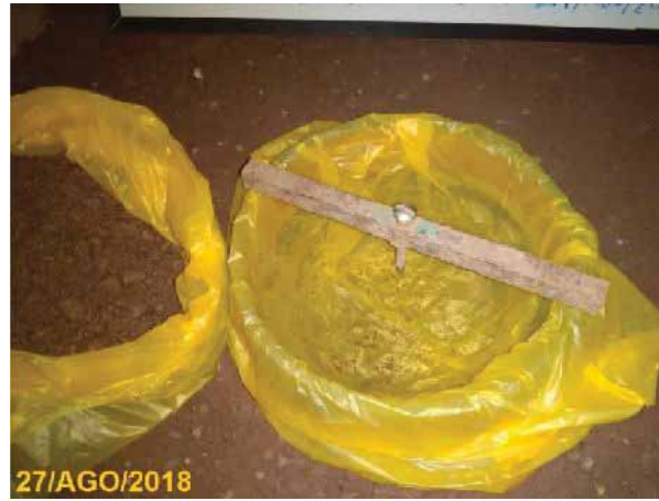
Imagen H.12: Ensayo de densidad a gran escala para gravas. Fuente: Fotografías propias.
