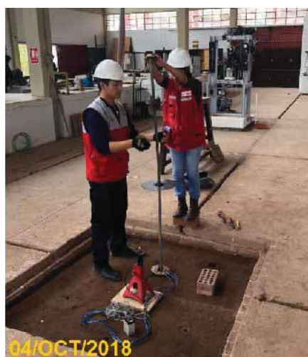
Imagen H.15: Ensayos PDC con medición electrónica en el pozo estratificado. Fuente: Fotografías propias.
