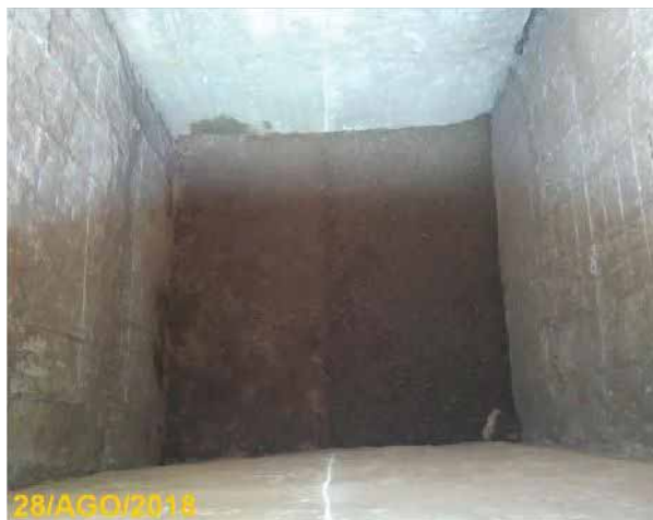
Imagen H.14: Conformación de estratos para el modelo experimental (pozo estratificado). Fuente: Fotografías propias.
