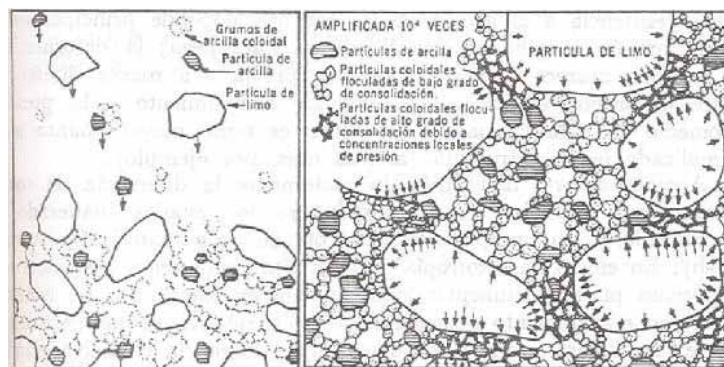
Figura 2.4. Estructuras compuestas de partículas del suelo Fuente: "Mecánica de Suelos", Juárez Badillo & Rico 2010, p.79
