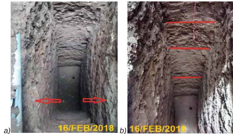
Imagen 6.1. Las fotografías muestran los estratos diferenciados de: a) Calicata "C" con presencia de traza con concreciones de margas. b) Calicata "C" con diferenciación de estratos Fuente: Fotografías propias.
