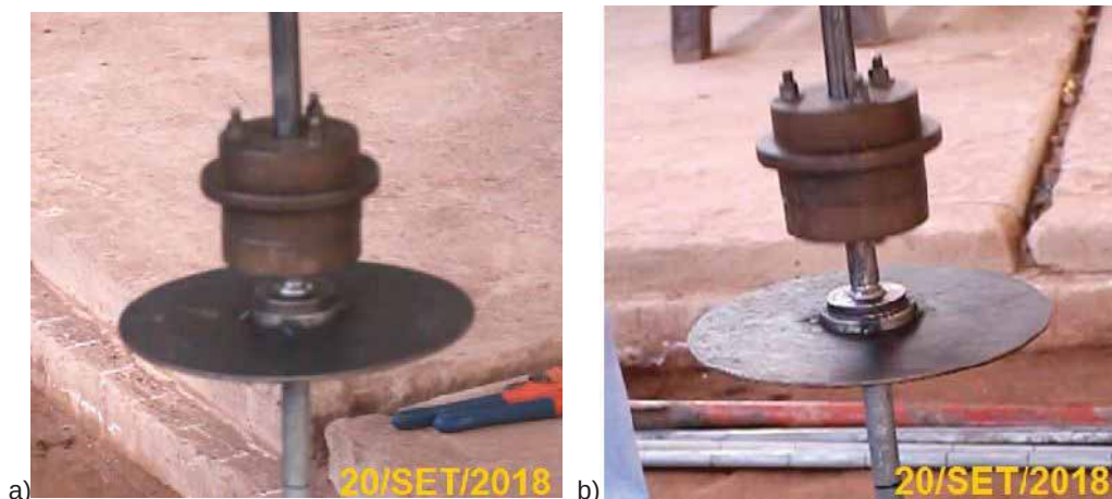
a) b) Imagen 5.1. En las fotografías se muestran instantes en que el martillo alcanza alturas máximas marcando el tipo rebote a) Rebote ligero. b) Rebote pronunciado.
