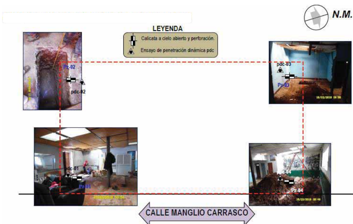
Diagrama 1.3. Croquis de puntos de investigación para la obtención de perfiles estratigráficos.
