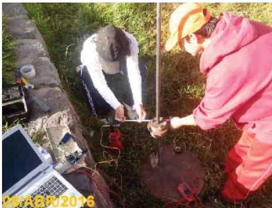
Imagen H.3: Comprobación de lecturas y calibración con el multímetro al sensor de sonido. Fuente: Fotografías propias.
