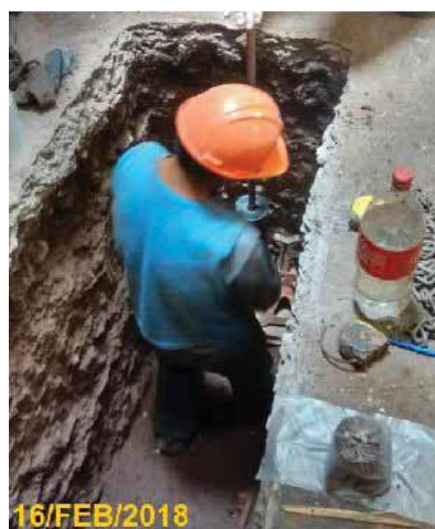
Imagen H.16: Perforación con tubos de muestreo continuo (Shellby) en estratos naturales. Fuente: Fotografías propias.
