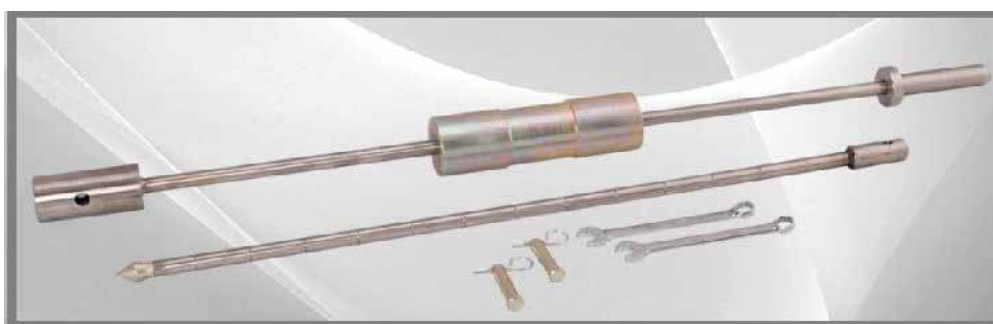
Imagen 2.3. DCP de masa única. Fuente: Catálogo Nro.11. HUMBOLDT, p. 23
