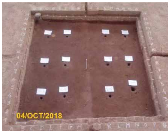
Imagen H.14: Pozo estratificado del modelo experimental antes y después de ensayos PDC. Fuente: Fotografías propias.
