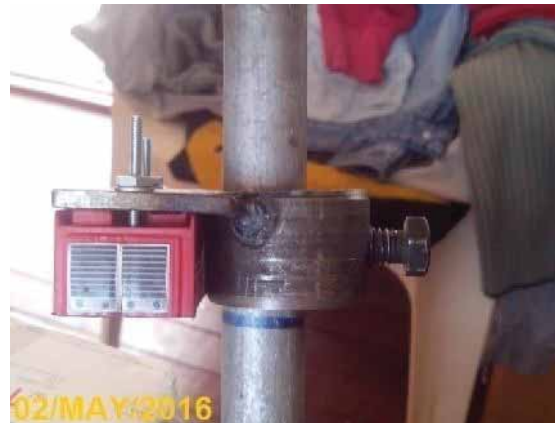
Imagen H.4: Diseño y construcción de caja protectora y gancho metálico que sostienen al sensor de ultrasonido del prototipo PDC-02.
