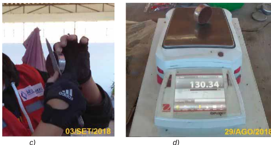
Imagen 4.2. Muestreo inalterado con anillos de borde cortante. a) Tapa de hinca y anillo en el suelo. b) Extracción de muestra y previo al enrase. c) Corte de bases a nivel. d) Pesaje de anillo y muestra.
