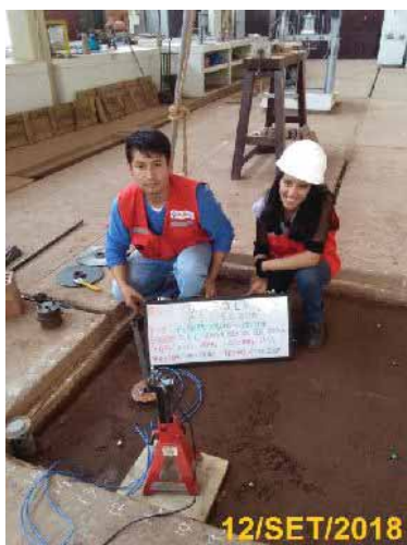
Imagen H.15: Ensayos PDC con medición electrónica en el pozo estratificado. Fuente: Fotografías propias.
