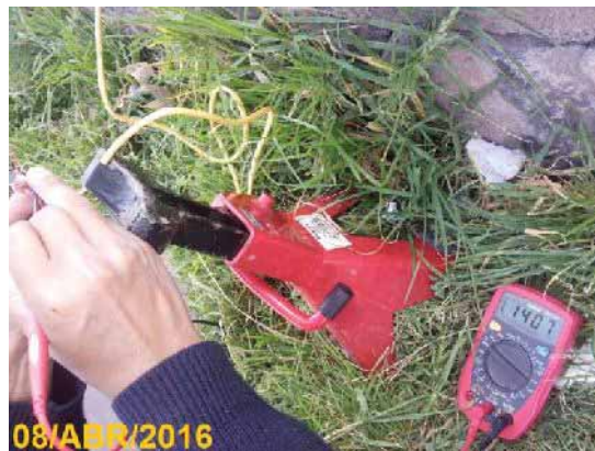
Imagen H.3: Comprobación de lecturas y calibración con el multímetro al sensor de sonido. Fuente: Fotografías propias.
