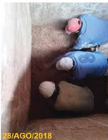
Imagen H.14: Conformación de estratos para el modelo experimental (pozo estratificado). Fuente: Fotografías propias.
