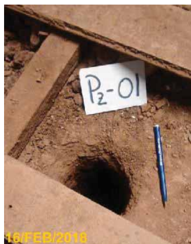
Imagen H.16: Perforación con tubos de muestreo continuo (Shellby) en estratos naturales. Fuente: Fotografías propias.
