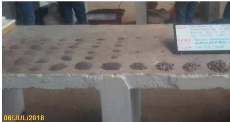
Imagen H.9: Análisis granulométrico por tamizado vía húmeda de muestras de suelo.
