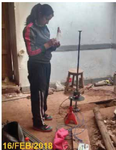
Imagen H.17: Ensayos PDC con medición electrónica en estratos naturales. Fuente: Fotografías propias.
