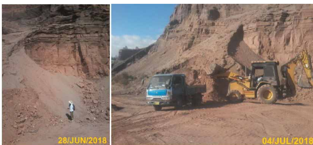
Imagen 1.1. Extracción de muestras de suelo a partir de estratos naturales en San Jerónimo, Cusco.
