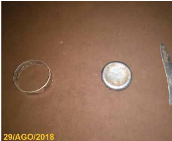
Imagen H.13: Muestreo inalterado con anillo de borde cortante. Fuente: Fotografías propias.
