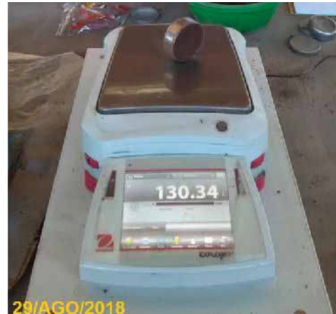
Imagen H.13: Muestreo inalterado con anillo de borde cortante. Fuente: Fotografías propias.
