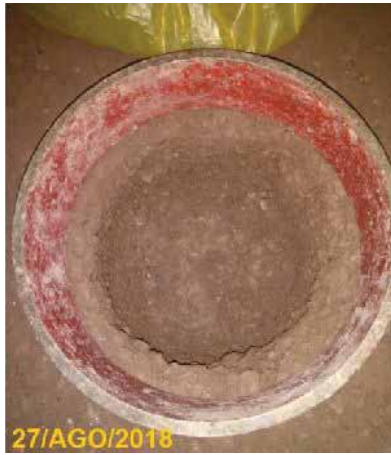
Imagen H.12: Ensayo de densidad a gran escala para gravas. Fuente: Fotografías propias.
