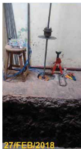
Imagen H.17: Ensayos PDC con medición electrónica en estratos naturales. Fuente: Fotografías propias.
