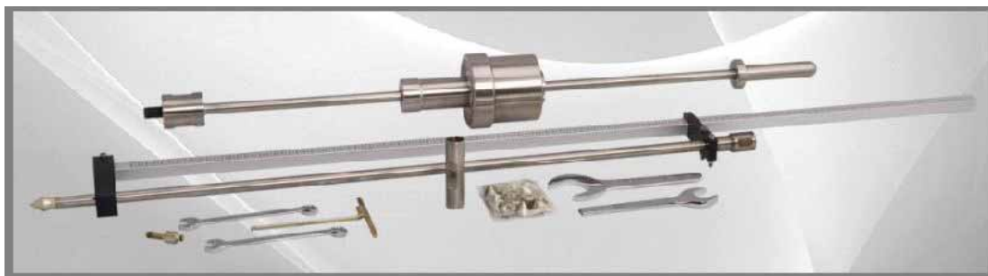
Imagen 2.1. DCP de masa dual. Fuente: Catálogo Nro11. HUMBOLDT, p. 22
