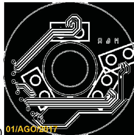
Imagen H.5: Diseño de circuitos impresos para la construcción del prototipo final de: a) Caja de procesamiento. b) Disco de medición.
