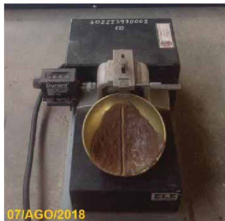
Imagen H.10: Ensayo de límites de consistencia para la obtención de: a) Límite líquido b) Límite plástico.
