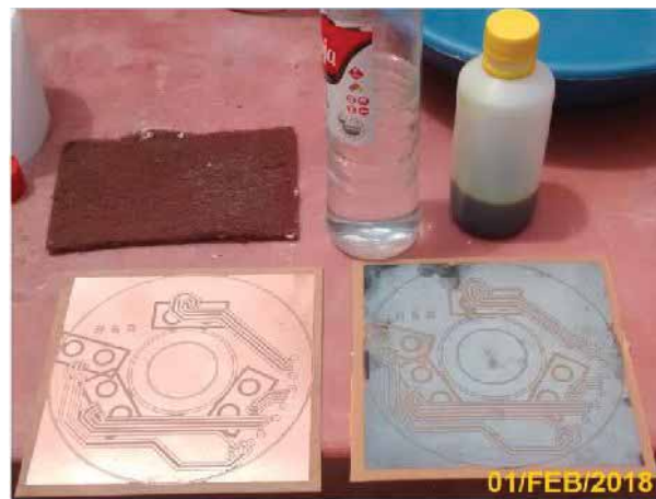
Imagen H.6: Oxidación, limpieza y pulido final de la lámina de cobre con el circuito impreso del disco de medición.
