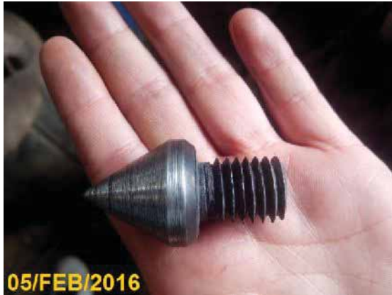
Imagen H.1: Fabricación local punta PDC, tubos PDC, martillo y yunque. Fuente: Fotografías propias.
