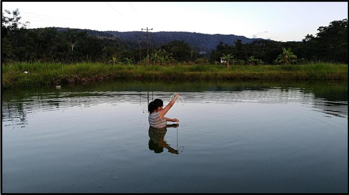
Medida de la transparencia y temperatura del agua del estanque.
