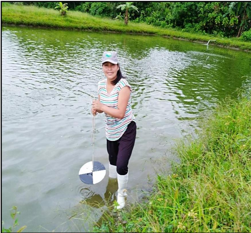
Medición de la transparencia con el disco de secchi. La cuerda que sostiene el disco está graduada en centímetros y la turbidez es medida a la profundidad en que ya no es posible ver el disco.
