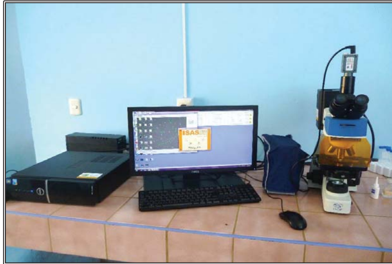
Foto 4: Equipo Integrated Sperm Analysis System (ISAS) CASA; microscopio de contraste de fases UB200i con cámara.
