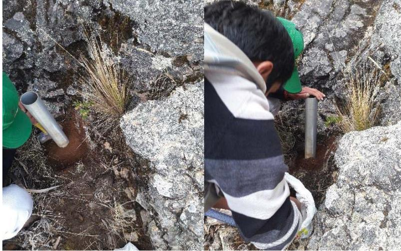
Foto 60. Pruebas de permeabilidad en la formación Kayra.
