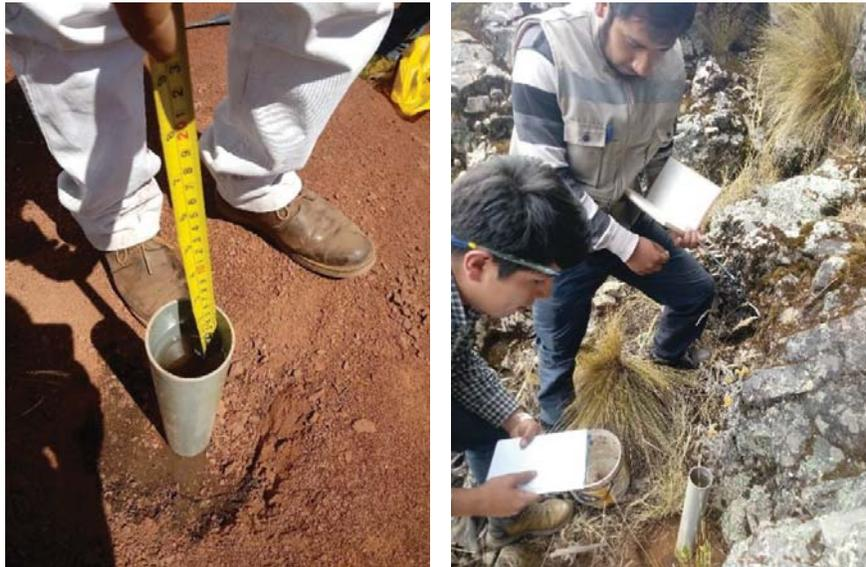
Foto 7. Prueba de carga constante en la formación Puquín, lutitas fracturadas (izq.). Pruebas de infiltración en la formación Kayra, en las fracturas del macizo rocoso (der.).
