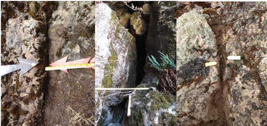
Foto 37. Apertura de fracturas en el macizo rocoso de la formación Kayra.
