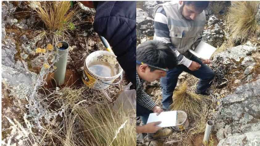
Foto 61. Pruebas de permeabilidad en la formación Soncco.
