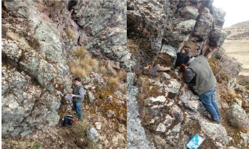
Foto 45. Medida de rumbo ( $N40^{\circ}$ ) y buzamiento ( $74^{\circ}SE$ ) de fracturas en la Formación Kayra.
