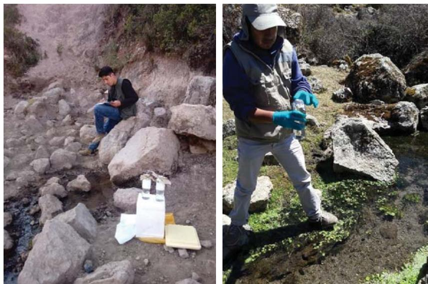
Foto 10. toma de muestras para análisis hidroquímicos. (izq.). toma de muestras para análisis microbiológicos (der)
