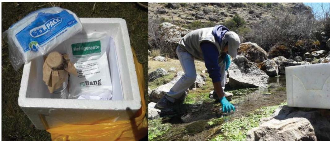
Foto 66. Conservación de muestra con geles refrigerantes (izq) y Muestreo de agua(der).
