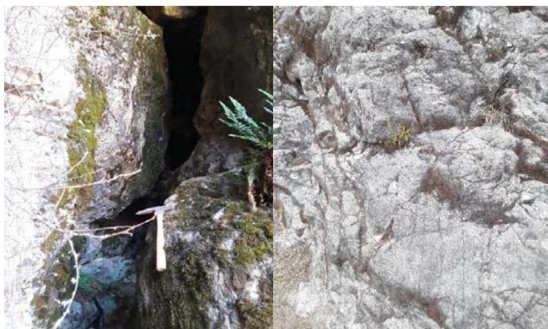
Foto 63. Transmisibilidad alta en la formación Kayra producto de fracturas de distensión de hasta 20 cm (izq.). Formación Kayra con fracturas cerradas y macizo compacto (der).
