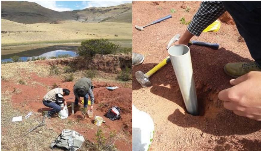
Foto 62. Prueba de permeabilidad en la formación Puquín.
