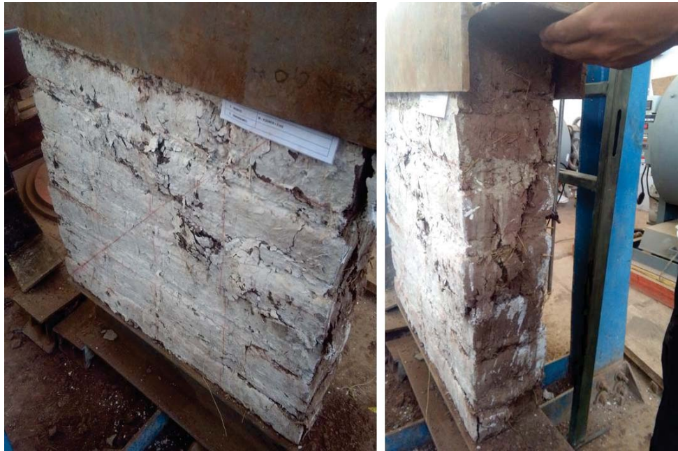
Figura 06.2. Tipo de falla registrado en ensayo de compresión en muretes.
