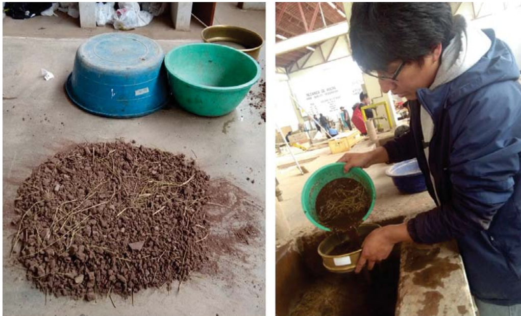
Figura 05.14. Lavado de material para determinar el contenido de paja.
