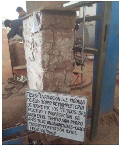
MURETES FALLADOS POR ENSAYO DE COMPRESIÓN AXIAL
