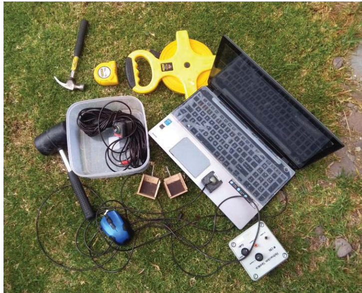
Figura 05.35. Equipo e instrumentos para ensayo de propagación de onda.
