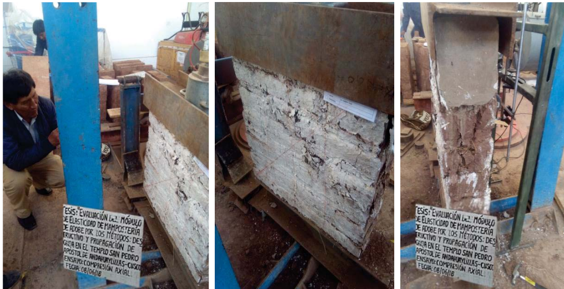
Figura 05.94. Tipo de fractura característica en los ensayos de compresión de muretes.
