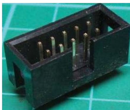
Figura 05.74. Terminal SPC 10 para entrada de indicadores. Fuente: Web.
