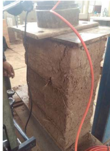
PILAS FALLADAS POR ENSAYO DE COMPRESIÓN AXIAL
