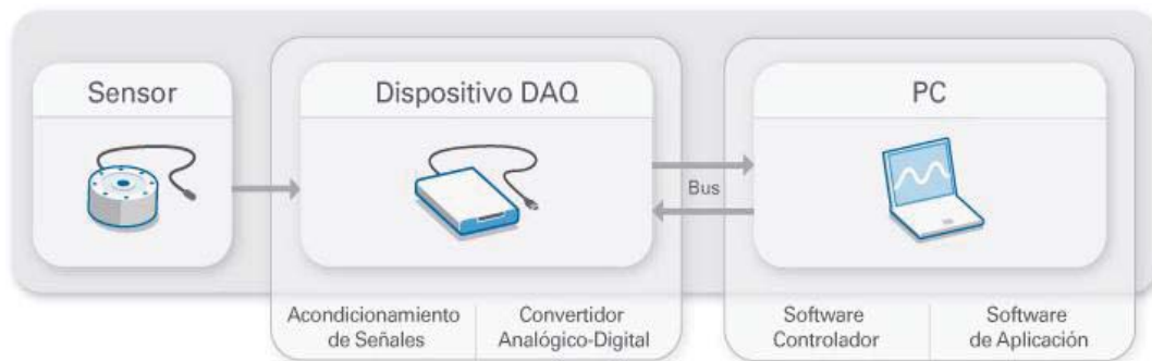
Figura 05.28. Partes de un sistema DAQ.
