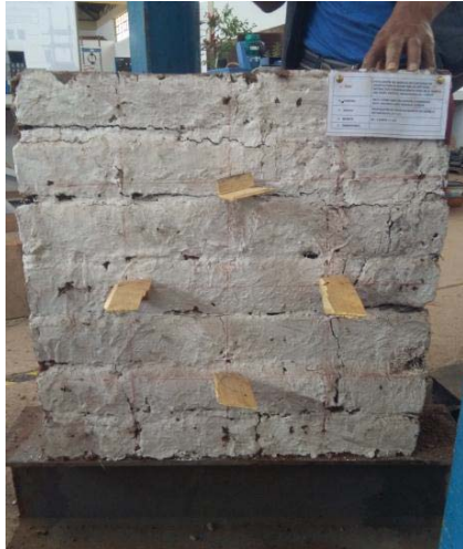
MURETES FALLADOS POR ENSAYO DE COMPRESIÓN AXIAL
