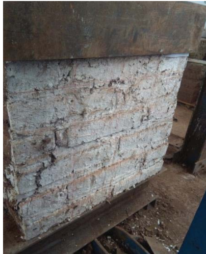
MURETES FALLADOS POR ENSAYO DE COMPRESIÓN AXIAL
