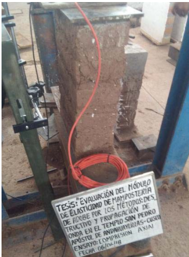
PILAS FALLADAS POR ENSAYO DE COMPRESIÓN AXIAL
