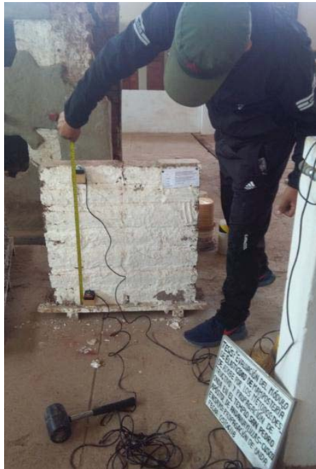
Figura 05.46. Medición de espaciamiento entre geófonos.
