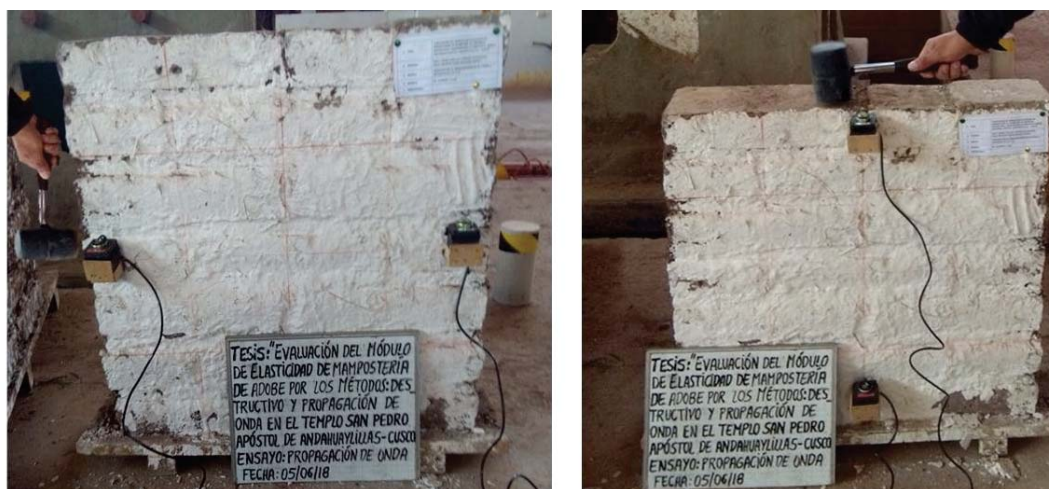
Figura 05.45. Configuración empleada para ensayos sónicos.
