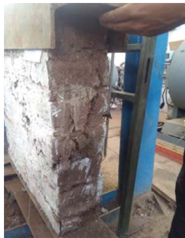
MURETES FALLADOS POR ENSAYO DE COMPRESIÓN AXIAL
