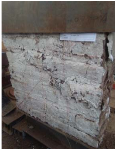
MURETES FALLADOS POR ENSAYO DE COMPRESIÓN AXIAL
