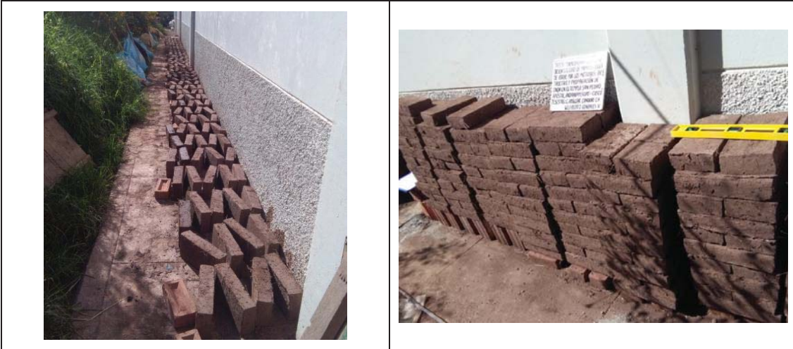
VOLTEADO Y RUMADO DE UNIDADES DE ADOBE
