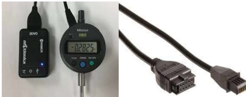
Figura 05.71. Indicador de deformación y cable específico de conexión.
