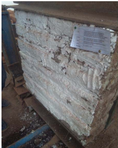
MURETES FALLADOS POR ENSAYO DE COMPRESIÓN AXIAL
