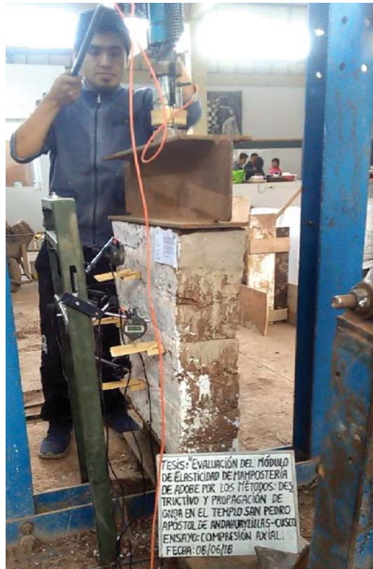
Figura 05.93. Murete de adobe instrumentado para ensayo de compresión.
