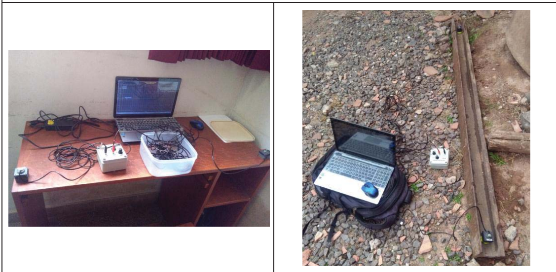
PRUEBA DE CALIBRACIÓN DE EQUIPO DE PROPAGACIÓN ONDAS EN MADERA Y ACERO
