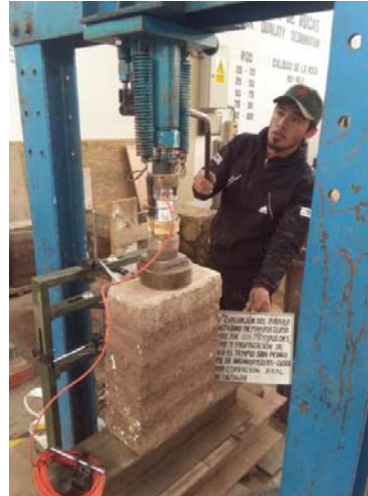
ENSAYO DE COMPRESIÓN AXIAL EN PILAS
