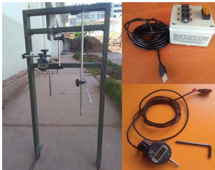
Figura 05.83. Equipo e instrumentos para ensayo de compresión axial.
