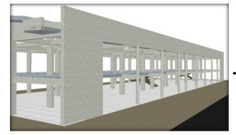
La imagen muestra el Sistema estructural del bloque académico del proyecto, se observa la modulación previa con respecto al distanciamiento entre columnas (luz), lo cual garantiza la carga equitativa de la estructura e influye en las dimensiones de estos elementos estructurales y su resistencia por cm2. (predimensionamieto).
