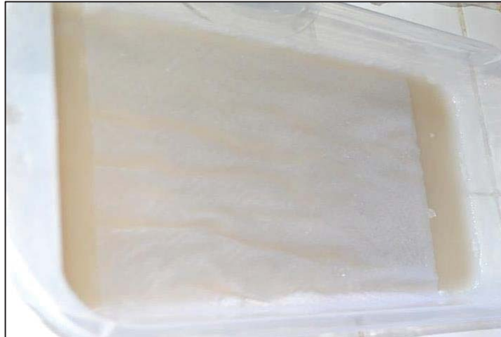
FIGURA 43: Papel secante impregnado con el concentrado mixto de esporas.
