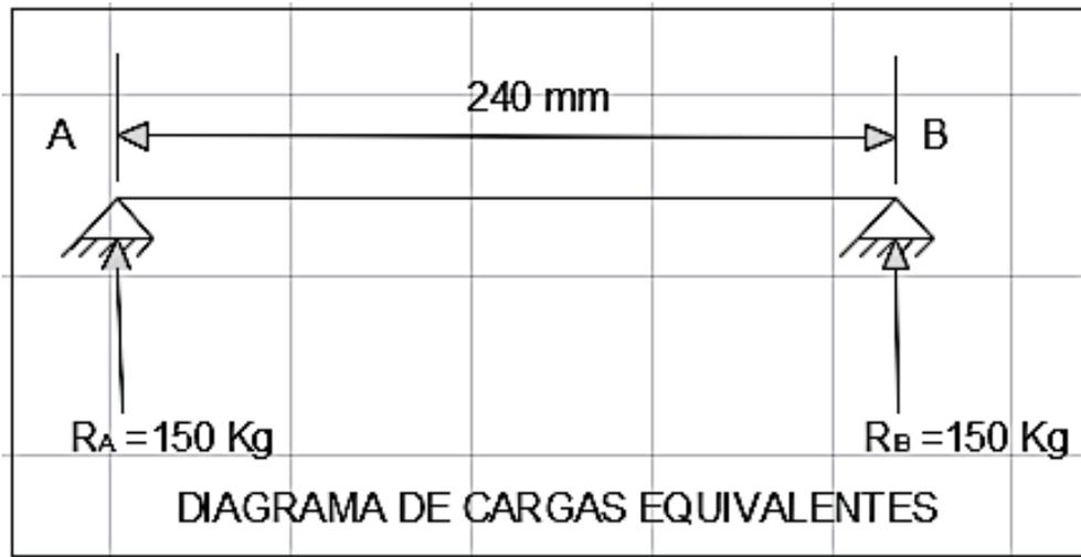
FIGURA 127 Diagrama de cargas equivalentes
