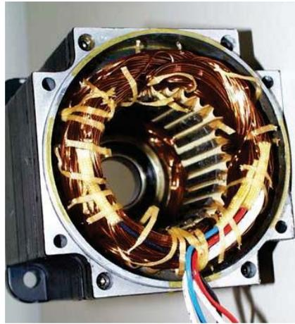
**FIGURA 122** Vista interior de motor síncrono
