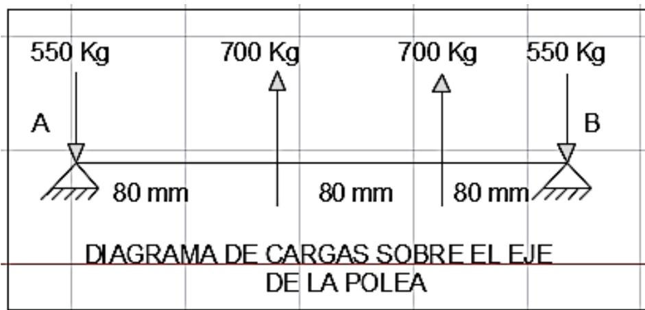
FIGURA 126 Diagrama de cargas sobre el eje de la polea
