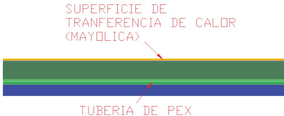
**Figura Nº 3. 67: vista lateral derecha del metro lineal de tubería.**
