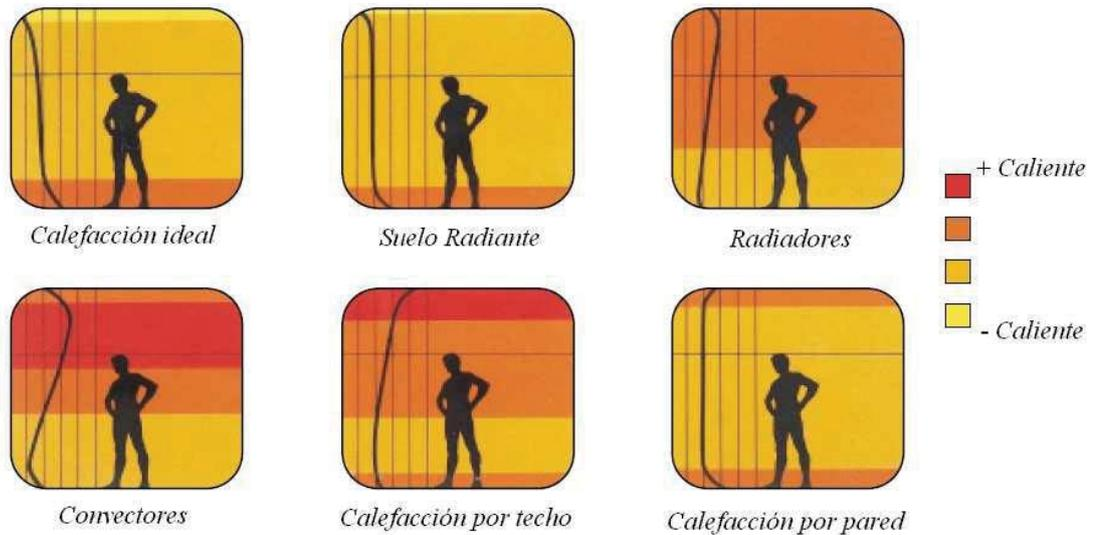
Figura N° 2. 1 Distribución vertical de temperaturas del aire en función del sistema de calefacción
