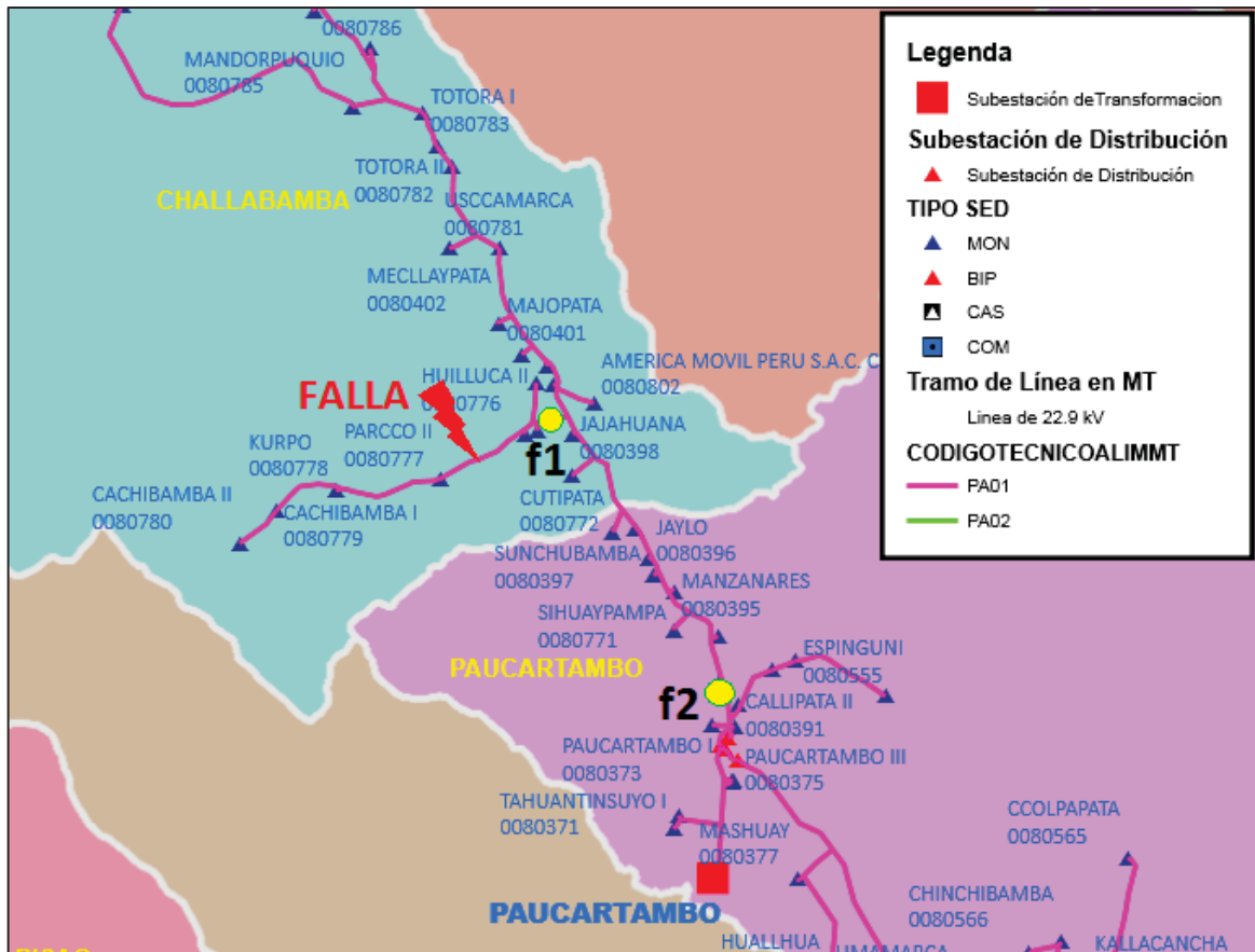
Figura 3.5.1. Falla en la red por caída de árbol.
