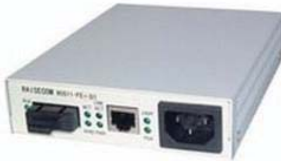
Fig. 5.3. Stand Alone RC001-1M chassis y conversor de medios RC512-FE-S-SS13.
