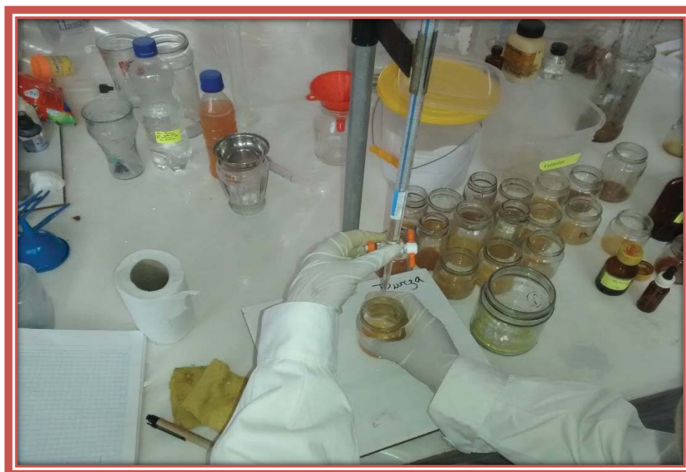
FOTOGRAFÍA N° 8: Determinación de \text{Cl}^- por el método de Mohr en la orina recolectada de los animales de experimentación. Laboratorio de área de Análisis por Instrumentación – CP Química – UNSAAC.
