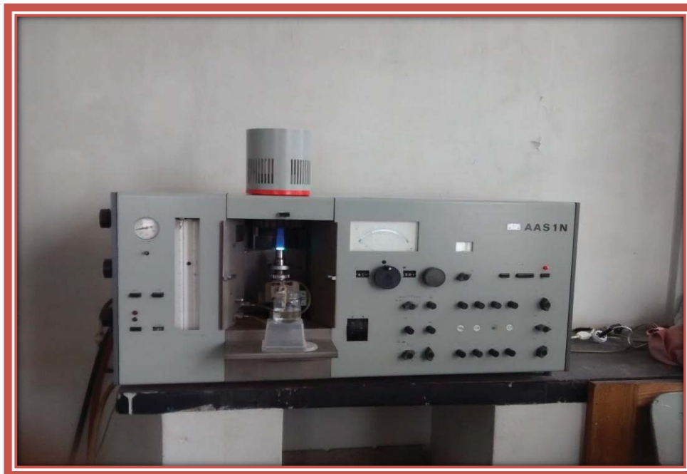
FOTOGRAFÍA N° 7: Determinación de \text{Na}^+ y \text{K}^+ por el método de absorción atómica en la orina recolectada de los animales de experimentación. Laboratorio de área de Análisis por Instrumentación – CP Química – UNSAAC.
