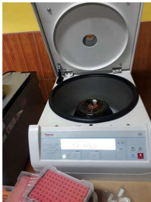
Anexo 18. Foto del equipo centrifuga con el que se centrifugó el chip con el adaptador de chips ion minifuge.
