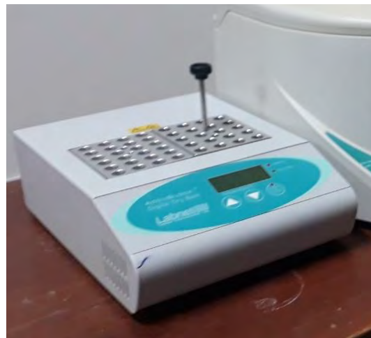
Anexo 9. Foto de equipo heat o baño seco a 65°C.
