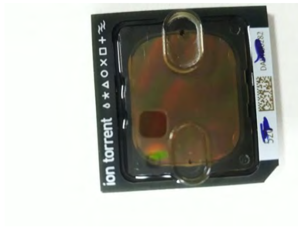
Anexo 17. Foto de Chip 520 usado retirado del secuenciador para cambiar el nuevo.
