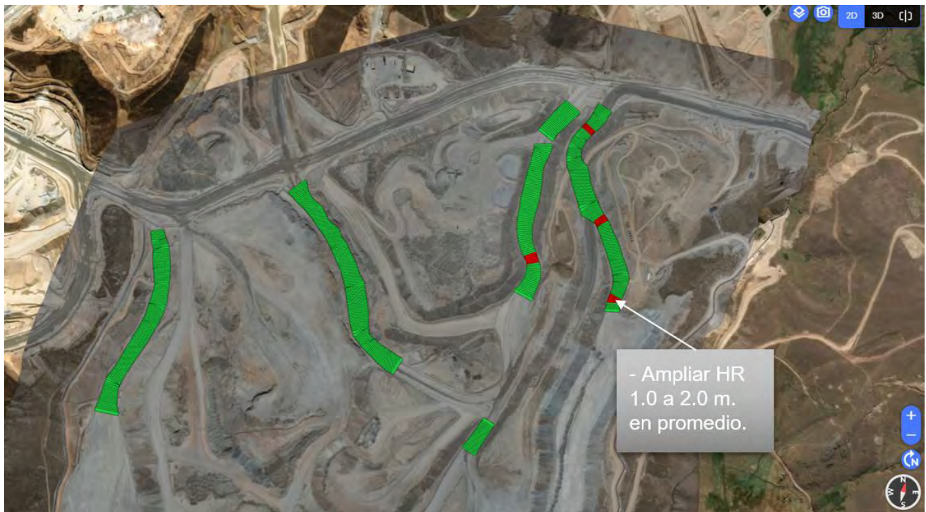
Figura 6: Tramos con anchos por remediar de las vías de acarreo hacia el WRF
