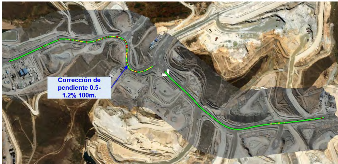
Figura 10: Tramos con pendiente por remediar de las vías hacia Canchadora
