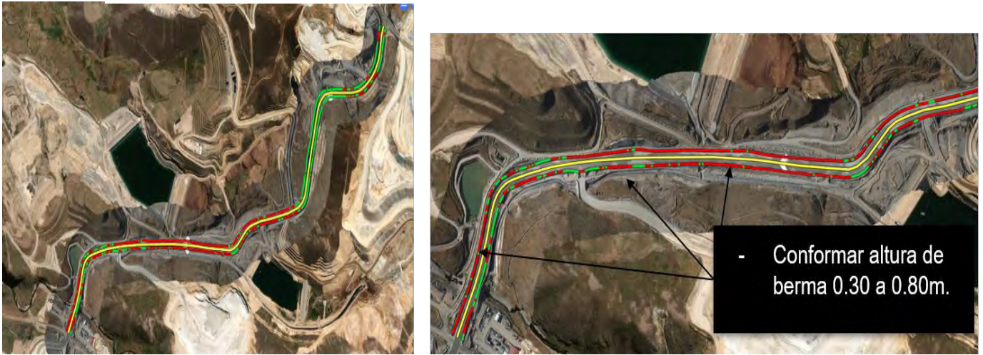
Figura 17: Tramos con bermas por remediar del Tajo Pampacancha
