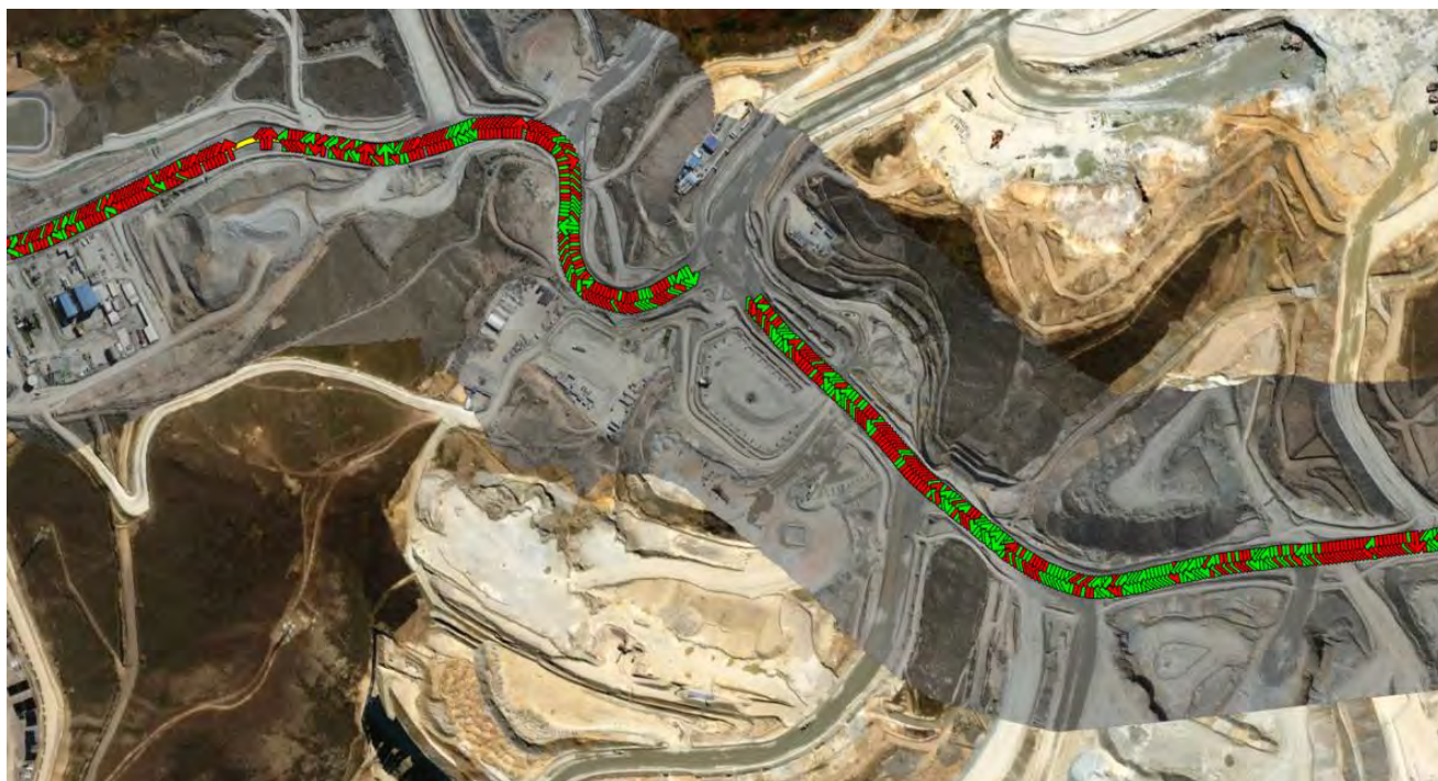
Figura 13: Tramos con peralte por remediar de las vías de acarreo hacia Chancadora
