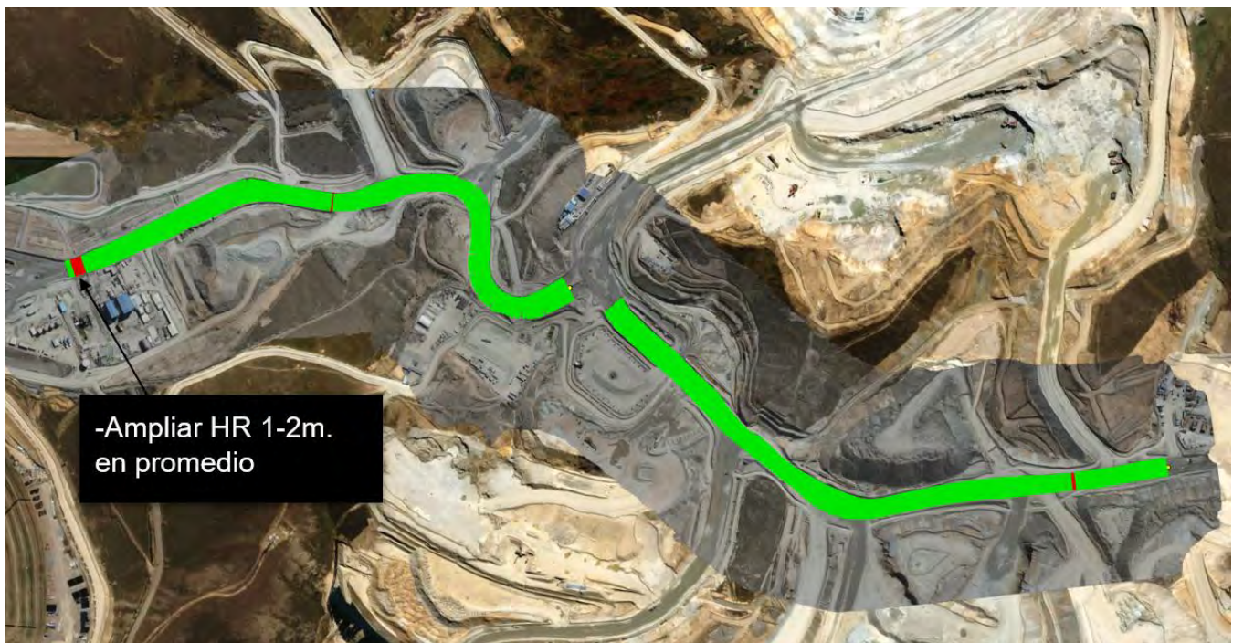
Figura 5: Tramos con anchos por remediar de las vías de acarreo hacia Chancadora
