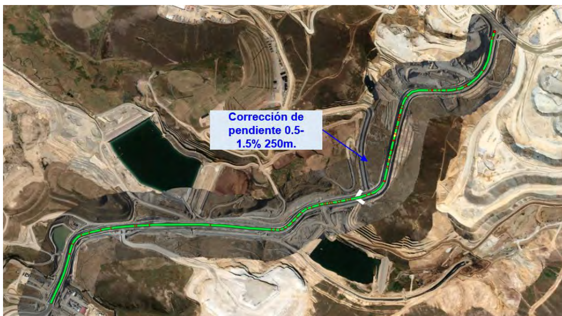
Figura 9: Tramos con pendiente por remediar de las vías de acarreo hacia el TMF
