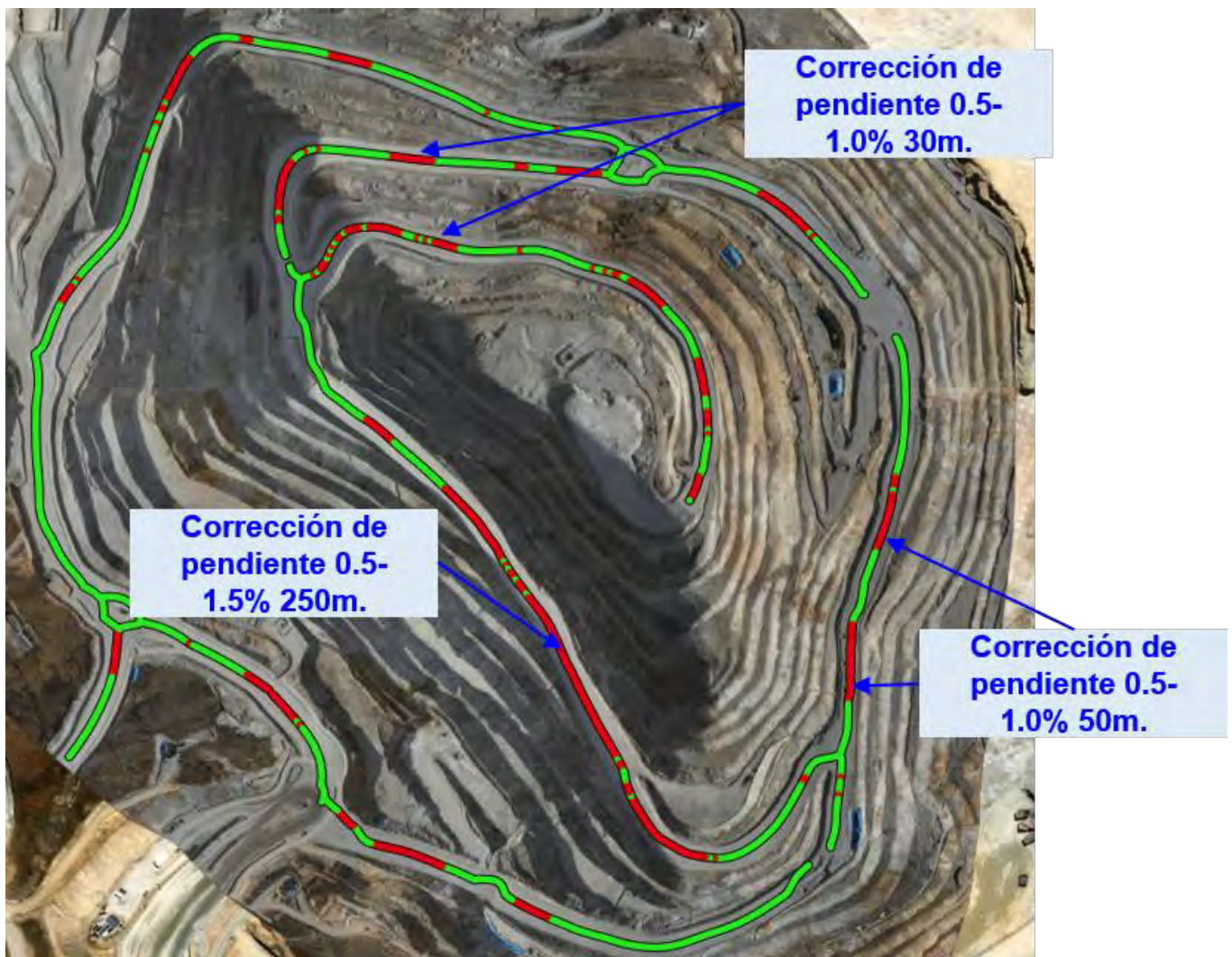
Figura 7: Tramos con pendiente por remediar del Tajo Constancia
