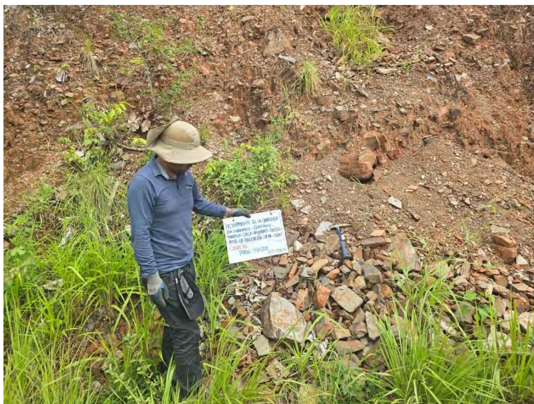
Fotografía 41: Deposito coluvio-deluvial constituido por clastos angulosos de pizarras y limos, Km 13+850.
