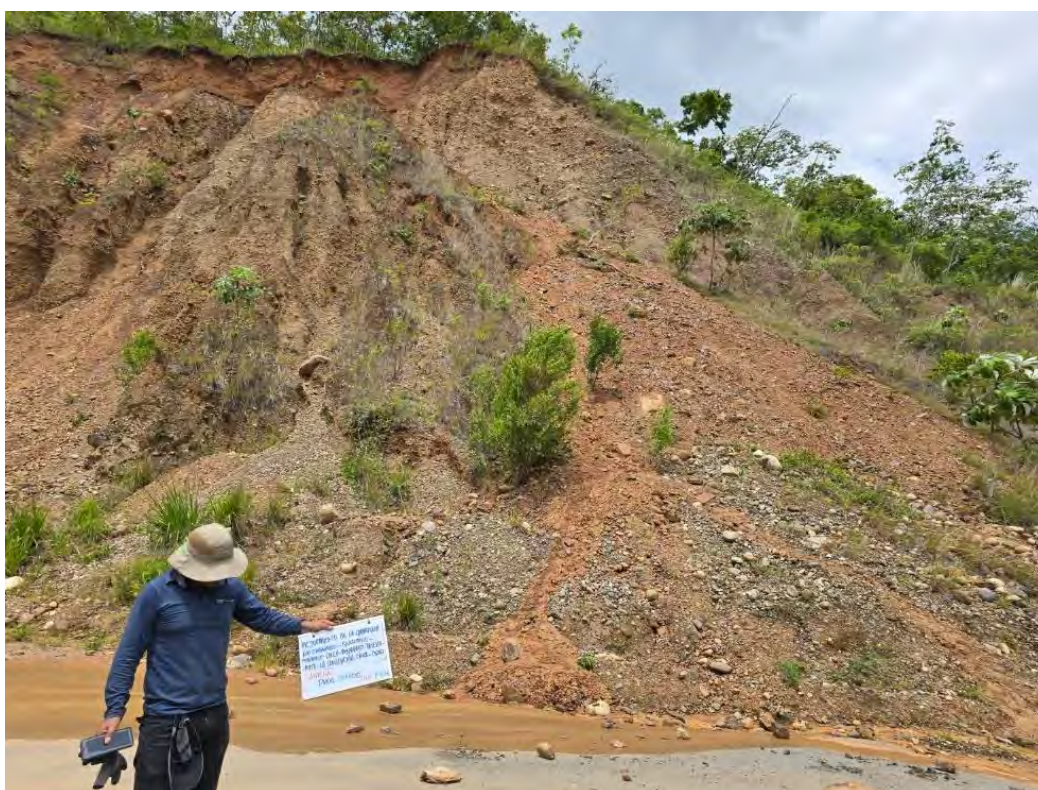
Fotografía 40: Depósito aluviofluvial constituido de material fluvial y aluvial constituido por gravas alteradas con clastos semiangulosos, arenas y limos, Km 01+600.
