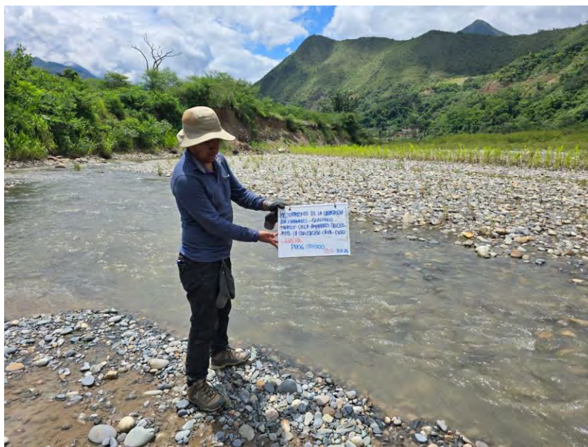
Fotografía 39: Deposito fluvial y aluvial constituido por gravas, cantos rodados y arenas; Terrazas fluviales. Foto tomada paralela al Km 01+250
