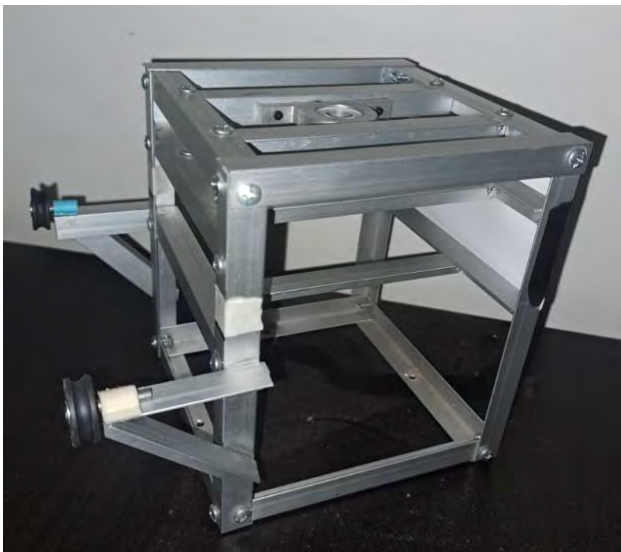
Figura 44. Estructura soporte fabricado en aluminio.
