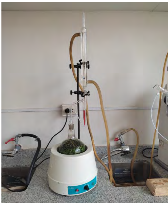
Fotografía 8: Equipo completo de hidrodestilación con trampa de cleverger.
