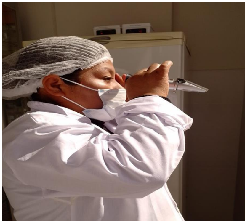
Imagen 17: Refractómetro empleado en la determinación de grados brix de la materia prima y el Jarabe de aguamiel de maguey ( Agave americana L.).
